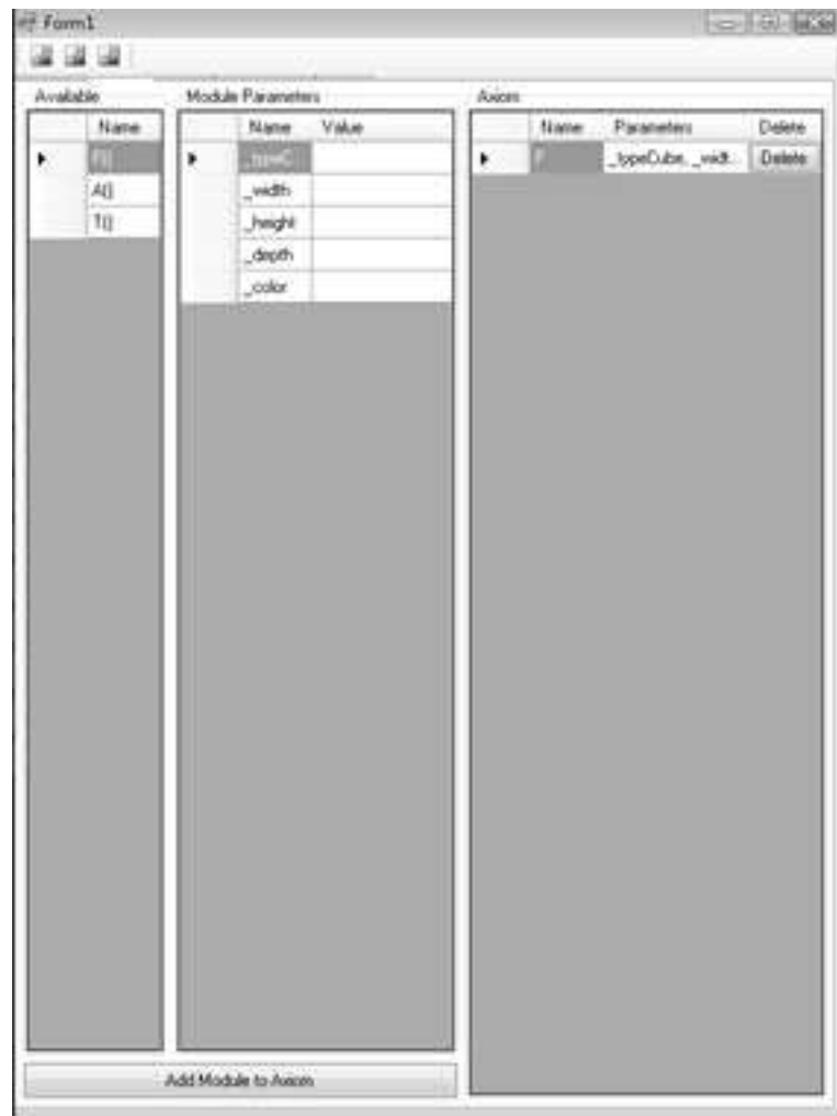
Obrázek C.2: Okno pro definici axiomu L-systému. Axiomem tohoto L-systému je modul F s parametry width=10 , height=5 a depth=5 .
