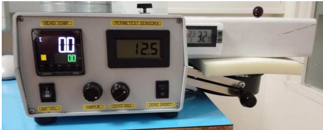
Obr. č. 21 Měření samostatné pěny na Permetestu
