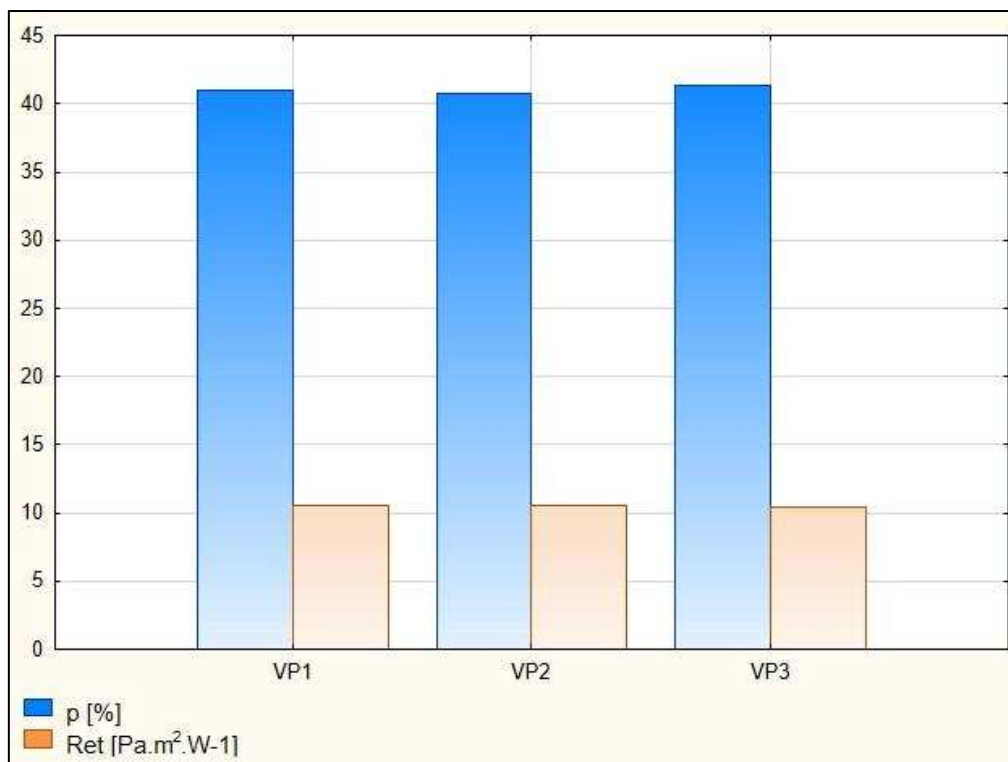
Obr. č. 18 Relativní paropropustnost vodních par a výparného odporu na samostatném suchém potahu
