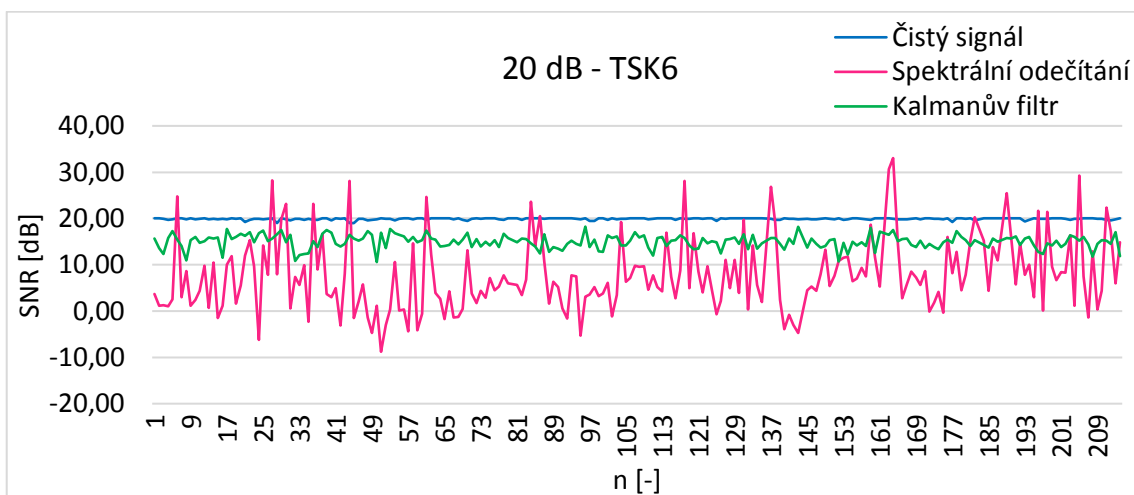
Obr. 8.12: Hodnoty SNR nahrávek prodloužené fonace – potlačení aditivního šumu s odstupem 20 dB od originálního signálu
