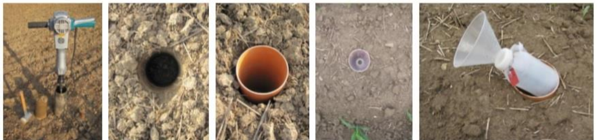
Obrázek 7 - Instalace záchytných trychtýřů pro měření kapkové eroze (foto Brant, 2010)
