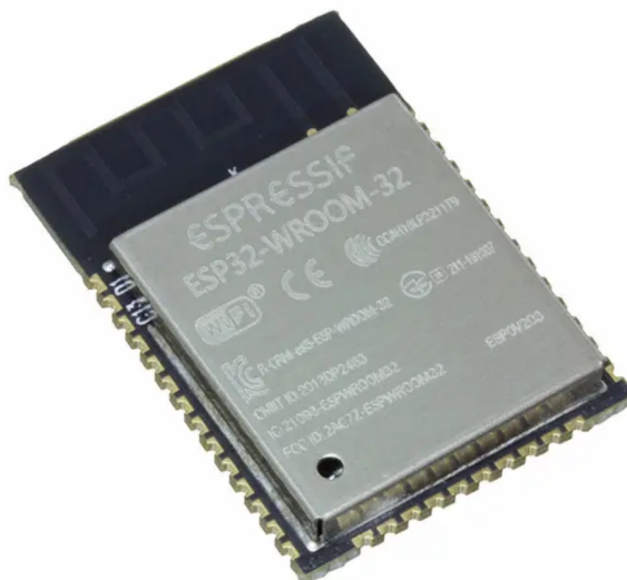
Obr. 3.7: Modul ESP32-WROOM-32 s čipom ESP32 . Čip so súčiastkami sa nachádza pod kovovým puzdrom. Zdroj https://www.robiz.net/esp32wroom32 .
