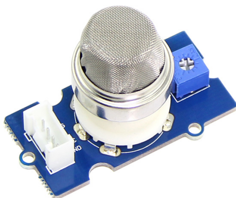
Obr. 3.11: Modul s plynovým senzorm MQ-2 . Na pravej strane má umiestnený potenciometer na nastavenie senzitivity. Zdroj http://wiki.seeedstudio.com/Grove-Gas_Sensor-MQ2/ .
