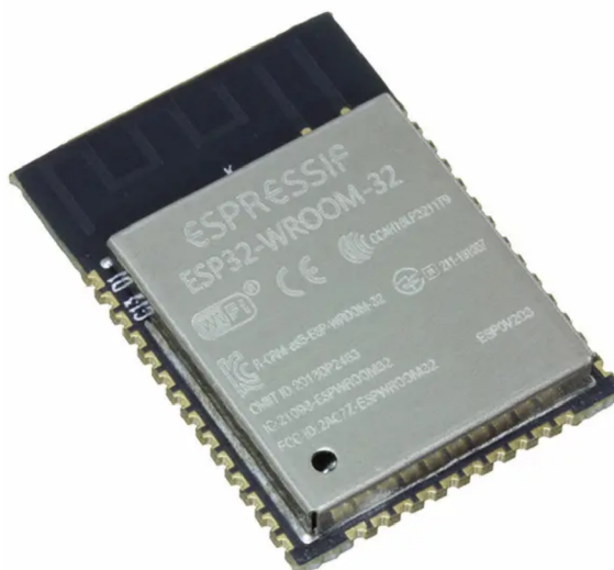
Obr. 3.7: Modul ESP32-WROOM-32 s čipom ESP32 . Čip so súčiastkami sa nachádza pod kovovým puzdrom. Zdroj https://www.robiz.net/esp32wroom32 .
