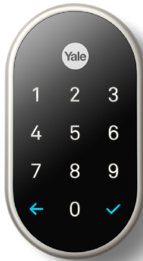
Obr. 2.13: Smart zámok Nest X Yale . Celý povrch zámku pokrýva dotyková číselná klávesnica určená na zadávanie prístupového kódu na odomknutie zámku. Zdroj https://www.thetimes.co.uk/article/smart-home-the-latest-gadgets-6th8zk8cc .
