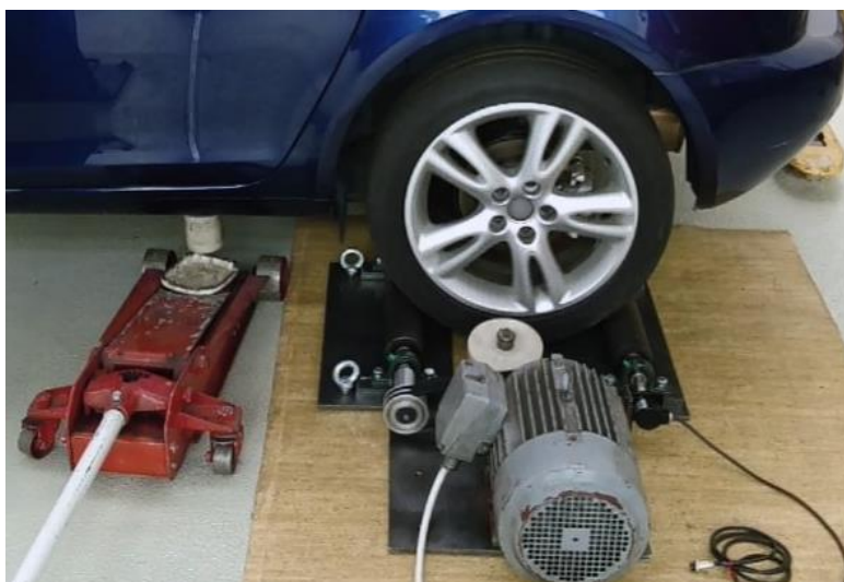
Obr. 73: Praktické usazení kola zkušebního vozidla na válcovou zkušebnu
