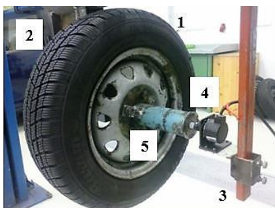
Obr. 30: Měření ventilačních ztrát a ložiska pneumatiky
