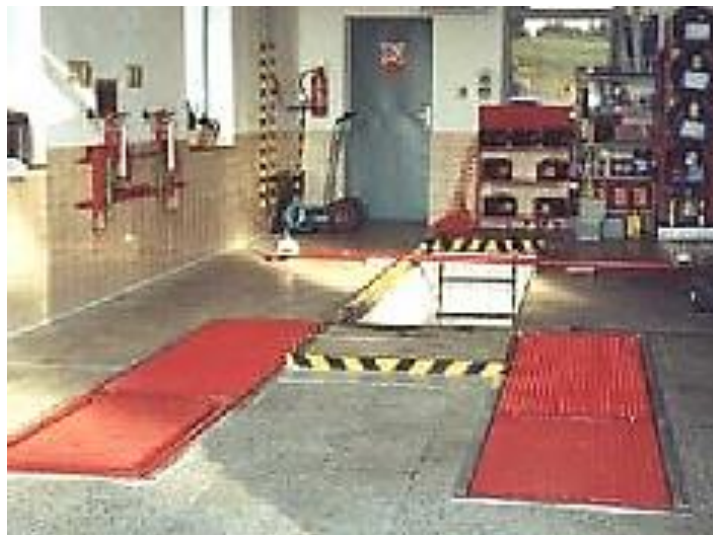
Obr. 14: Plošinová zkušebna brzdného účinku silničních vozidel [3]
