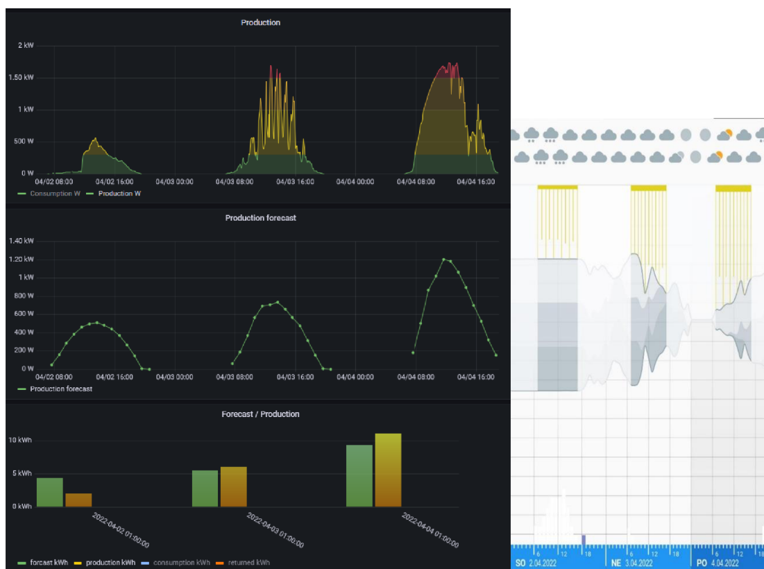
Obrázek 28 Porovnání přesnosti předpovědi při různých typech oblačnosti Zdroj: Autor, Aplikace pro předpověď oblačnosti [48]
