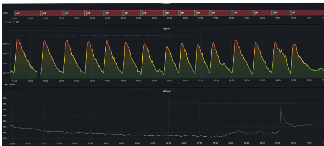
Obrázek 33 Graf fungování termostatu na teplotě 20,5 °C
