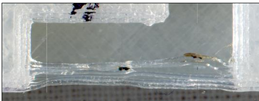
Obr. 94 Jediné zhotovené premostenie. Materiál nylon, teplota trysky 260 °C, rýchlosť tlače 25 mm/s
