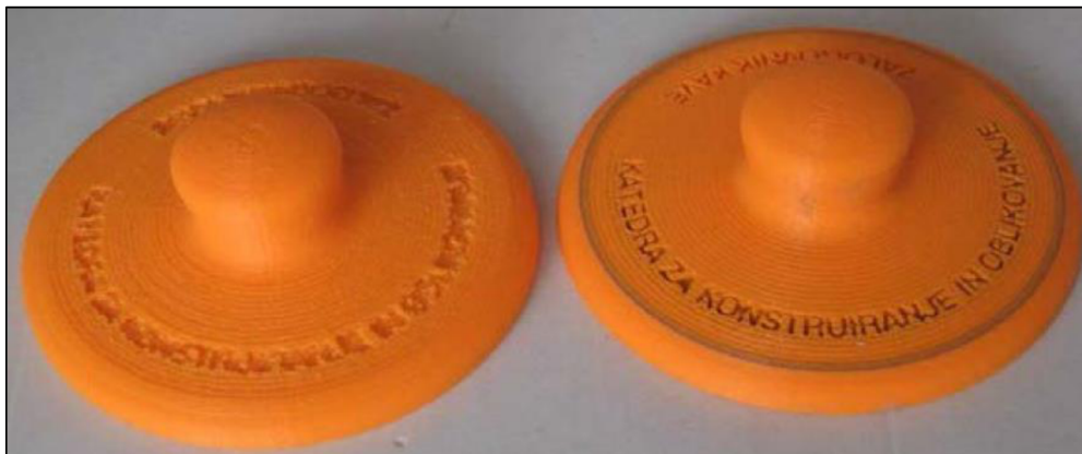
Obr. 19 Rovnaký objekt, ktorého g kód bol vytvorený v softvéri Cura vľavo a v Repetier vpravo [61]
