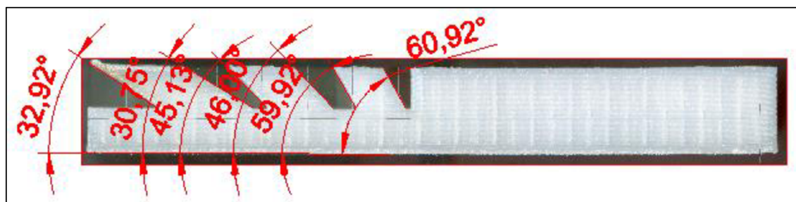
Obr. 63 Meranie rozmerov z naskenovaného obrázku bočnej plochy pomocou CAD softvéru DraftSight.
