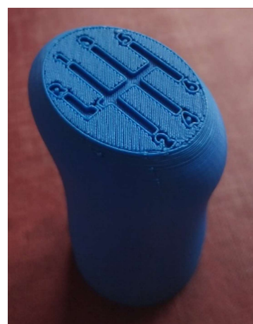
Obr. 28 - Vytištěný model bez podpůrného materiálu
