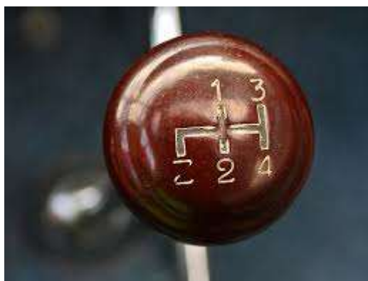
Obr. 1 - Bakelitová řadicí páka [2]
