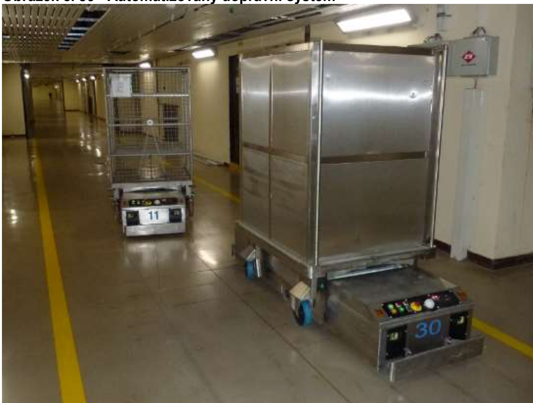
Obrázek č. 30 - Automatizovaný dopravní systém
