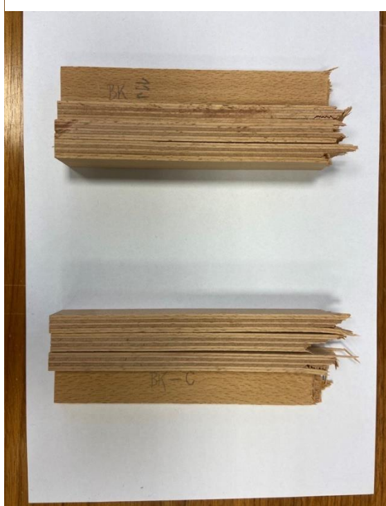
Obrázek 41 Méně houževnatý lom u BK
