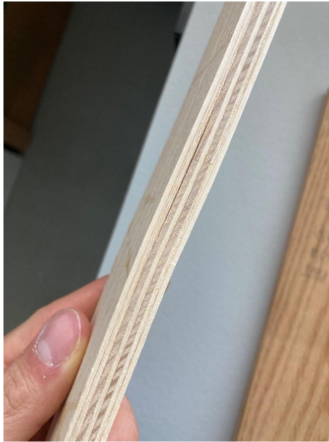
Obrázek 38 Ukázka delaminace vzorku při ohybu
