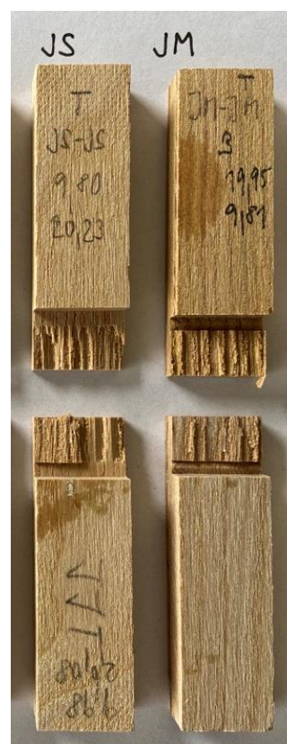
Obrázek 35 Porušení lepeného spoje ve dřevě, JS/JM
