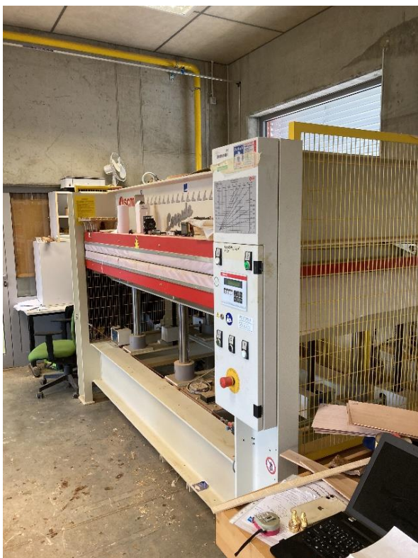
Obrázek 19 Dýhovací lis scm Leopida gs 6/90
