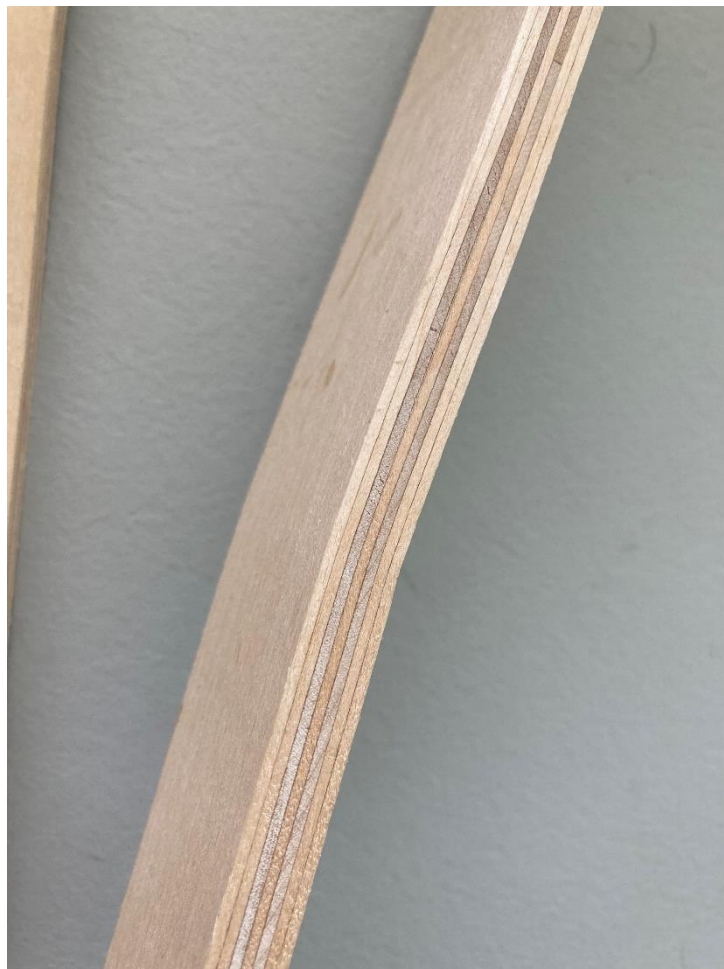
Obrázek 37 Zkušební těleso z BK po ohybové zkoušce
