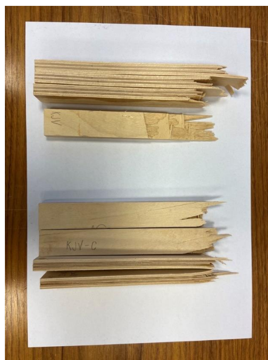
Obrázek 40 Houževnatý lom u KJ
