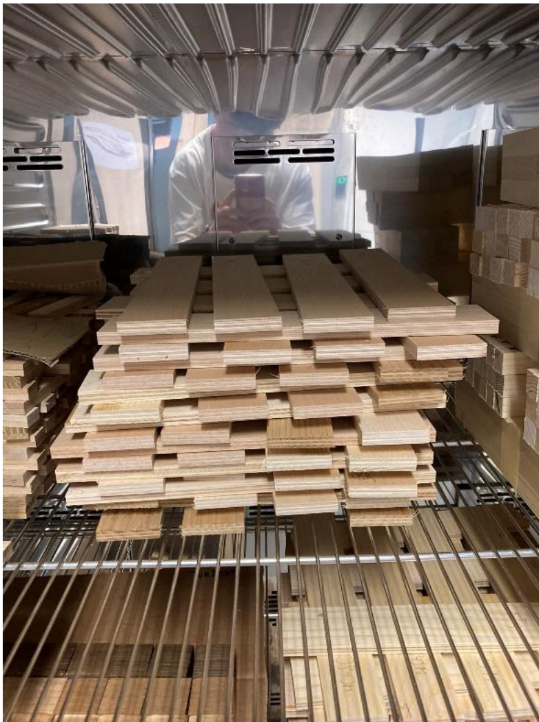
Obrázek 22 Kondicionování vzorků na ohybové zkoušky
