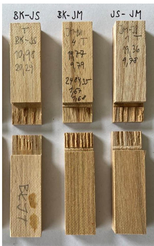
Obrázek 34 Porušení lepeného spoje kombinovaných skladeb
