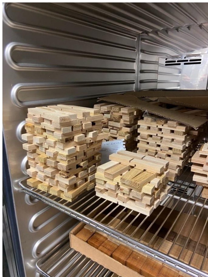
Obrázek 23 Kondicionování vzorků pro zkoušku pevnosti lepeného spoje
