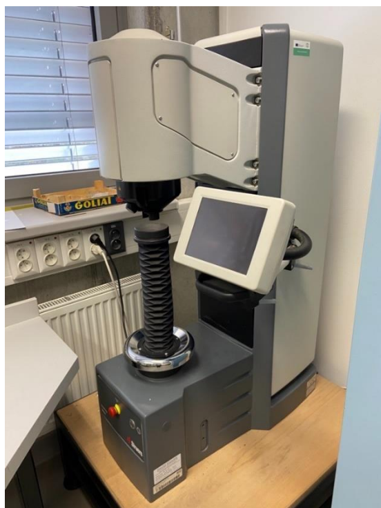
Obrázek 24 Tvrdoměr Struers DuraVision-30
