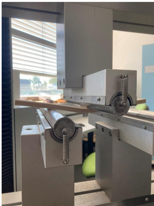
Obrázek 28 Statický tříbodový ohyb
