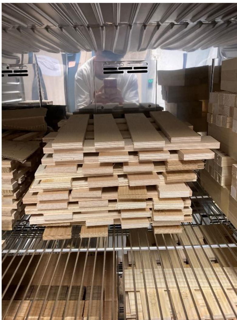
Obrázek 22 Kondicionování vzorků na ohybové zkoušky
