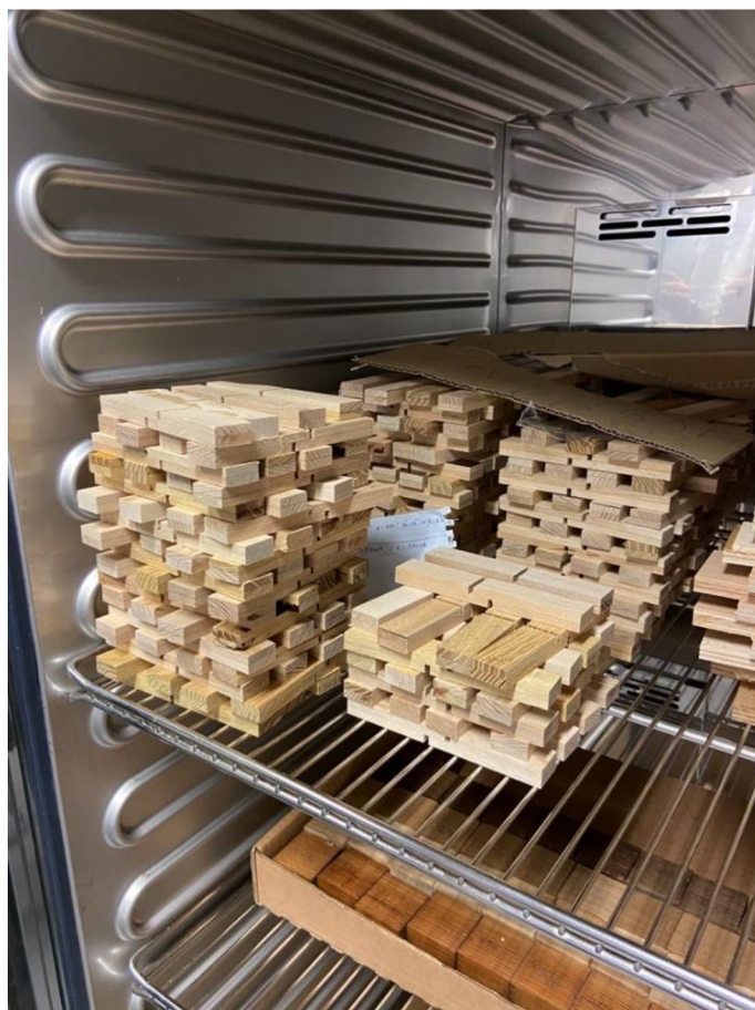
Obrázek 23 Kondicionování vzorků pro zkoušku pevnosti lepeného spoje
