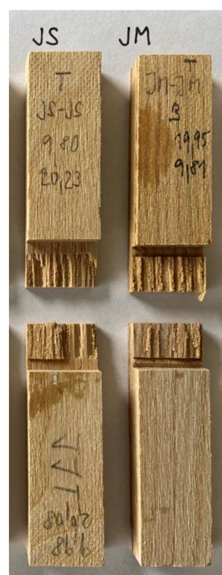
Obrázek 35 Porušení lepeného spoje ve dřevě, JS/JM
