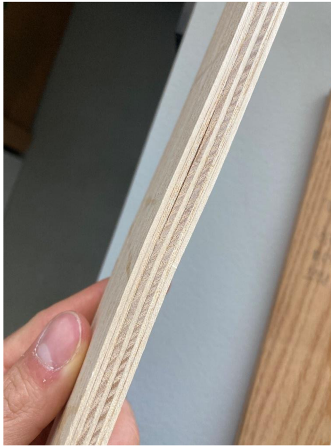
Obrázek 38 Ukázka delaminace vzorku při ohybu
