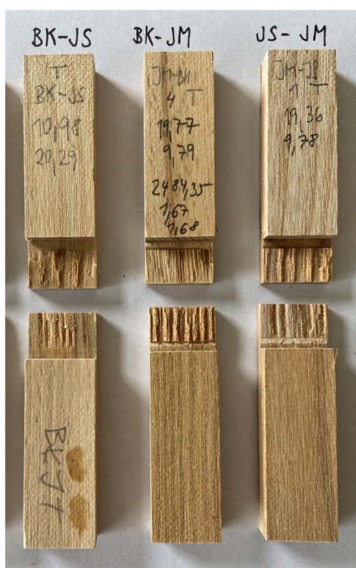
Obrázek 34 Porušení lepeného spoje kombinovaných skladeb
