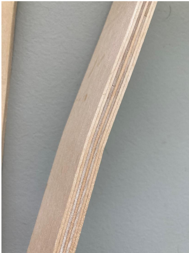
Obrázek 37 Zkušební těleso z BK po ohybové zkoušce
