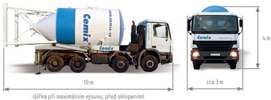
Obrázek 44 Silostavěč M-tec na podvozku DAF CF 400 FAD, přepravní rozměry (5)
