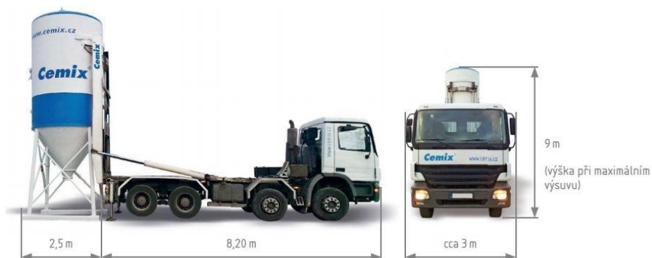
Obrázek 45 Silostavěč M-tec na podvozku DAF CF 400 FAD, rozměry při stavění (5)
