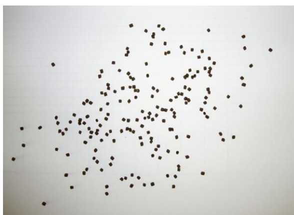
Obr. 11 a 12. Pohled na granule ležící na podnosu při manuálním počítání a výstup z programu pro manuální počítání granulí z digitální fotografie v programu MicroImage™ v. 4.0
