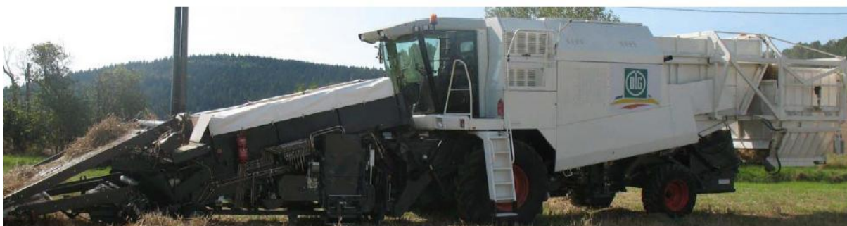
Obr. 12 Nejnovější generace laboratorní mlátičky, používané od roku 2010. Stroj, na základě sklízecí mlátičky Claas, vyrobila německá společnost MDW Singwitz [28]
