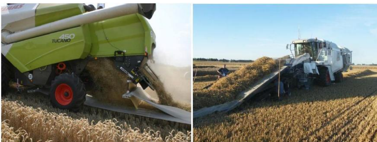
Obr. 13 Plnění slámy a plev s úhrabky na sběrné pásy, umístěné před a za zadní nápravou testované sklízecí mlátičky. Ty jsou následně přiváděny na naviják adaptéru laboratorní mlátičky současně [28]
