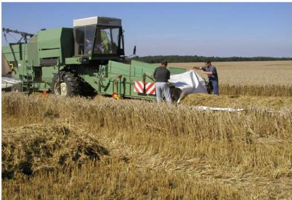
Obr. 11 Upravená laboratorní mlátička E 514 při zkouškách v německé zkušebně DLG, bílá plachta se zachyceným materiálem testované sklízecí mlátičky je připevňována na naviják [28]
