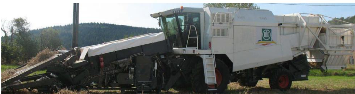
Obr. 12 Nejnovější generace laboratorní mlátičky, používané od roku 2010. Stroj, na základě sklízecí mlátičky Claas, vyrobila německá společnost MDW Singwitz [28]
