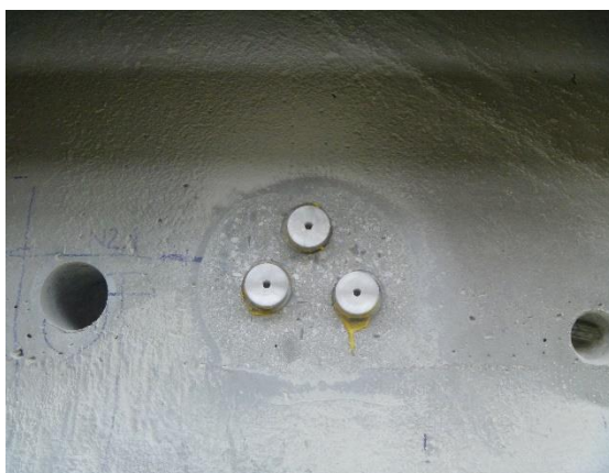
Obrázek 138: Příklad zkušebního místa s přilepenými zkušebními terči
