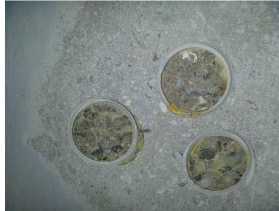
Obrázek 57: Zkušební plocha po provedení odtrhové zkoušky
