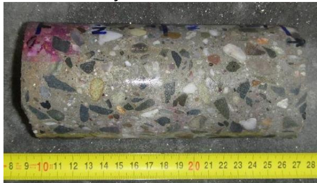
Obrázek 117: Laboratorní foto odebraného vzorku betonu z vývrtu VN1.10
