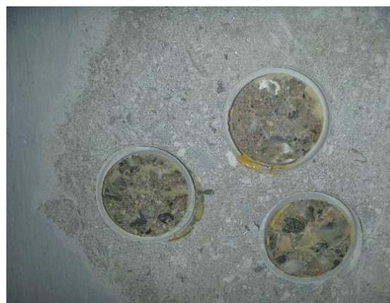
Obrázek 139: Příklad zkušebního místa po provedení odtrhové zkoušky
