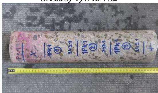
Obrázek 82: Laboratorní foto odebraného vzorku betonu z vývrtu VK2
