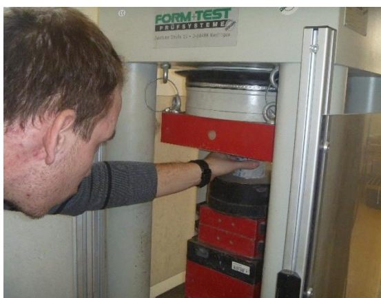
Obrázek 51: Zkoušení zkušebních těles v hydraulickém lisu Form+Test
