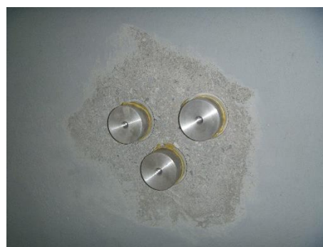
Obrázek 36: Místo připravené pro provedení odtrhové zkoušky
