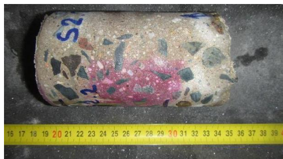
Obrázek 153: Laboratorní foto odebraného vzorku betonu z vývrtu VS2.9-2.10
