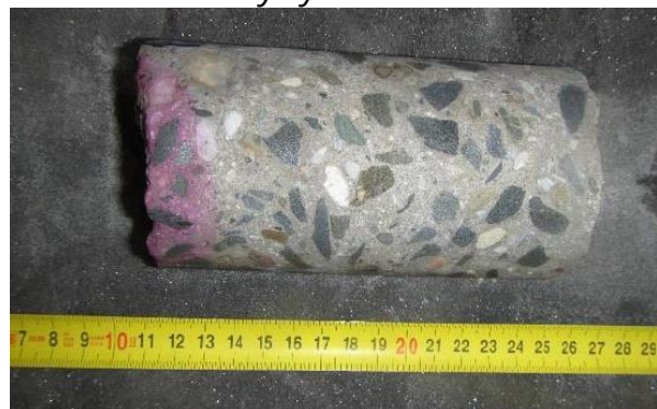
Obrázek 125: Laboratorní foto odebraného vzorku betonu z vývrtu V2N1.1
