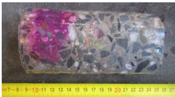
Obrázek 37: Stanovení hloubky karbonatace na jádrovém vývrtnu pomocí fenolftaleinového testu. Hloubka karbonatace u vzorku dosahuje hloubky 8-10 mm
