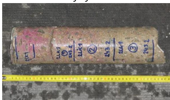
Obrázek 78: Laboratorní foto odebraného vzorku betonu z vývrtu VK1
