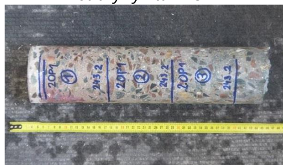
Obrázek 66: Laboratorní foto odebraného vzorku betonu z vývrtu V2OP1
