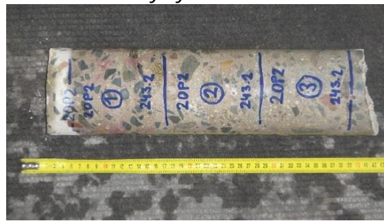
Obrázek 90: Laboratorní foto odebraného vzorku betonu z vývrtu V2OP2
