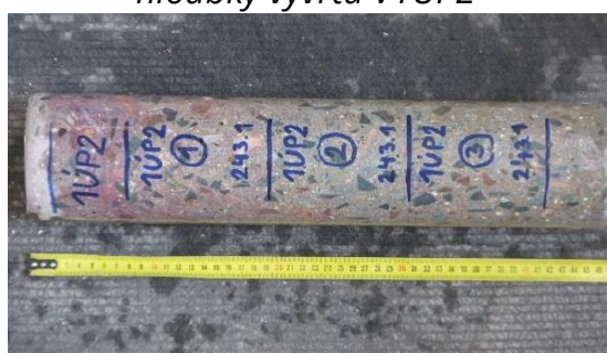
Obrázek 94: Laboratorní foto odebraného vzorku betonu z vývrtu V1ÚP2
