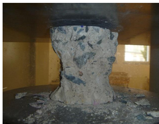
Obrázek 52: Porušení zkušebního tělesa do tvaru přesýpacích hodin
