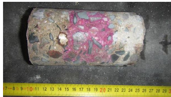
Obrázek 150: Laboratorní foto odebraného vzorku betonu z vývrtu VS1.1-1.2
