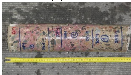
Obrázek 62: Laboratorní foto odebraného vzorku betonu z vývrtu V1OP1
