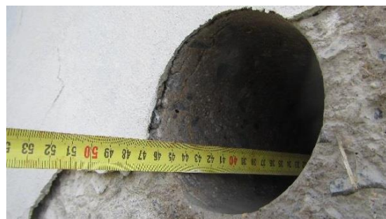
Obrázek 72: Detailní foto měření hloubky vývrtu V2ÚP1
