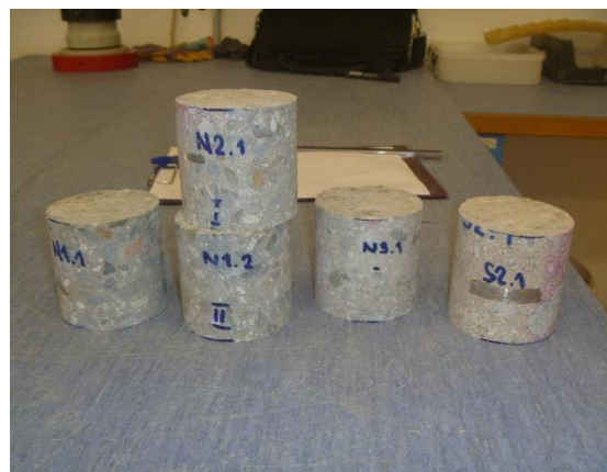
Obrázek 34: Zkušební tělesa připravené z jádrových vývrtů na zkoušení v lisu
