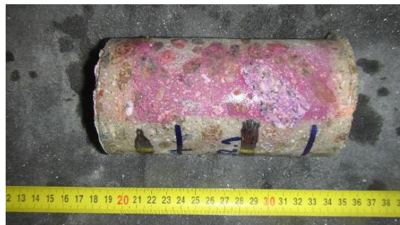
Obrázek 144: Laboratorní foto odebraného vzorku betonu z vývrtu VS2.1-2.2
