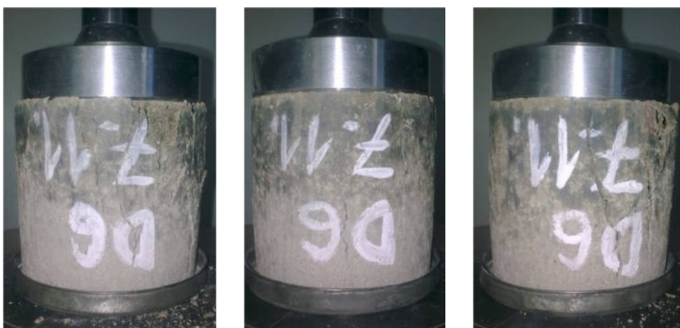
Obr. 3.31: Vyskúšané valčeky na pevnosť v tlaku po MC, Doroport TB 25 6%, w_{opt} = 6,5\%
