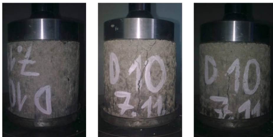
Obr. 3.34: Vyskúšané valčeky na pevnosť v tlaku po MC, Doroport TB 25 10%, w_{opt} = 9,5\%
