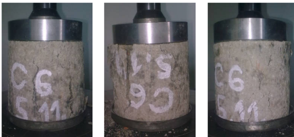
Obr. 3.11: Vyskúšané valčeky na pevnosť v tlaku, cement 6%, w_{opt} = 6,5\%
