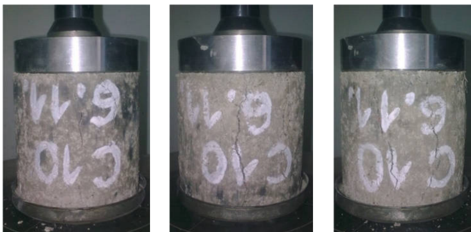
Obr. 3.14: Vyskúšané valčeky na pevnosť v tlaku, cement 10%, w_{opt} = 10,0\%
