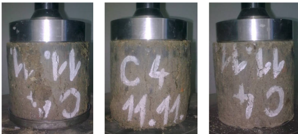
Obr. 3.24: Vyskúšané valčeky na pevnosť v tlaku po MC, cement 4%, w_{opt} = 6,5\%
