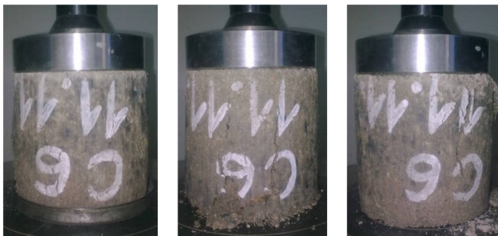
Obr. 3.25: Vyskúšané valčeky na pevnosť v tlaku po MC, cement 6%, w_{opt} = 6,5\%
