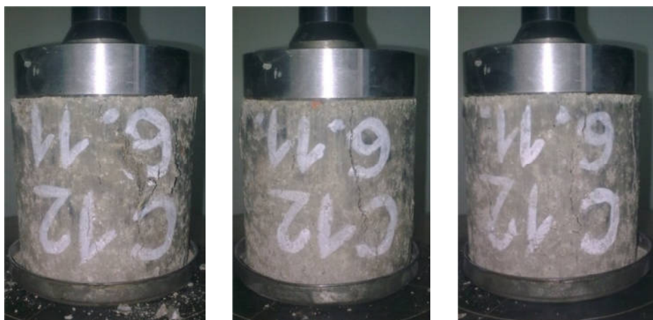
Obr. 3.15: Vyskúšané valčeky na pevnosť v tlaku, cement 12%, w_{opt} = 10,0\%
