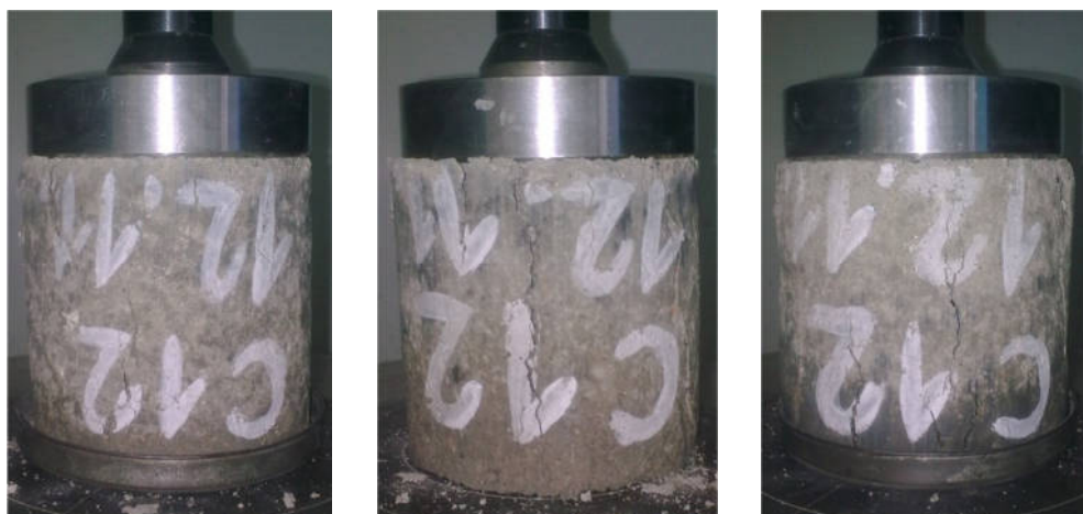
Obr. 3.29: Vyskúšané valčeky na pevnosť v tlaku po MC, cement 12%, w_{opt} = 10,0\%
