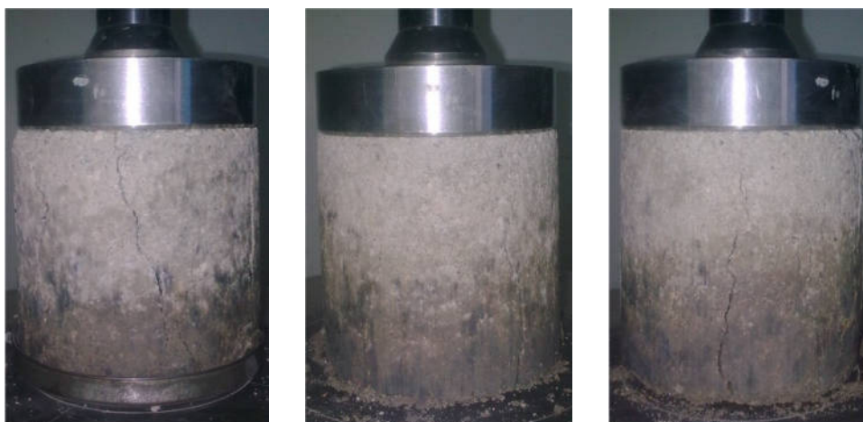
Obr. 3.21: Vyskúšané valčeky na pevnosť v tlaku, Doroport TB 25 12%, w_{opt} = 9,5\%
