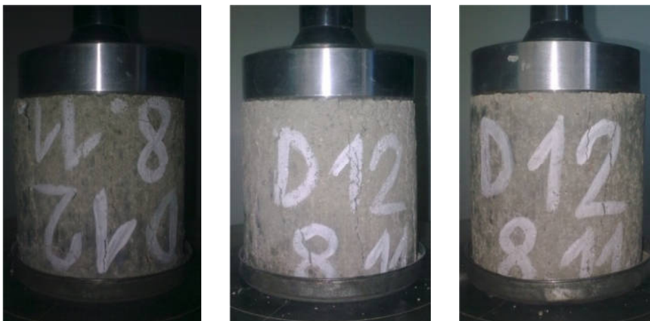
Obr. 3.35: Vyskúšané valčeky na pevnosť v tlaku po MC, Doroport TB 25 12%, w_{opt} = 9,5\%
