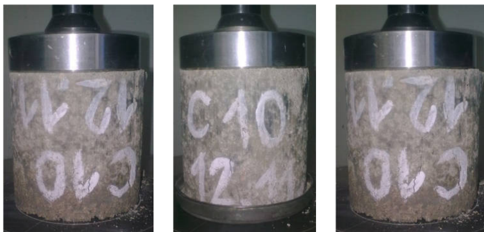
Obr. 3.28: Vyskúšané valčeky na pevnosť v tlaku po MC, cement 10%, w_{opt} = 10,0\%
