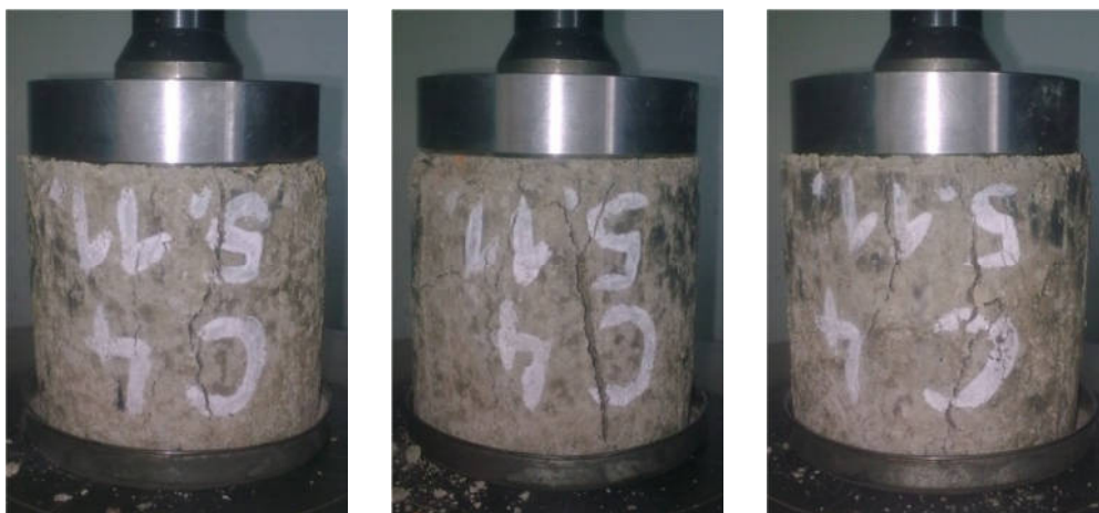
Obr. 3.10: Vyskúšané valčeky na pevnosť v tlaku, cement 4%, w_{opt} = 6,5\%
