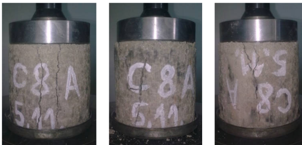
Obr. 3.12: Vyskúšané valčeky na pevnosť v tlaku, cement 8%, w_{opt} = 6,5\%
