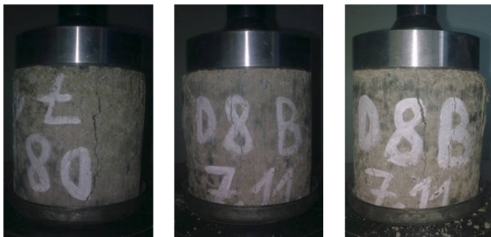
Obr. 3.33: Vyskúšané valčeky na pevnosť v tlaku po MC, Doroport TB 25 8%, w_{opt} = 9,5\%
