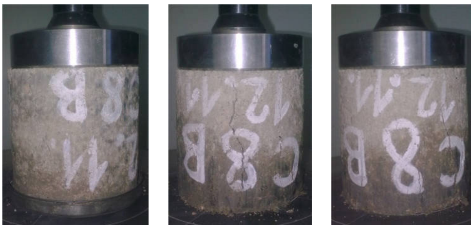
Obr. 3.27: Vyskúšané valčeky na pevnosť v tlaku po MC, cement 8%, w_{opt} = 10,0\%
