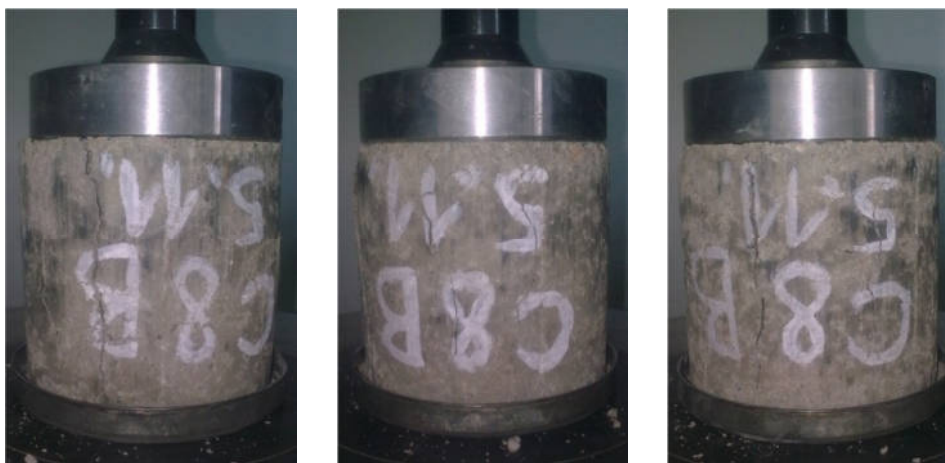
Obr. 3.13: Vyskúšané valčeky na pevnosť v tlaku, cement 8%, w_{opt} = 10,0\%
