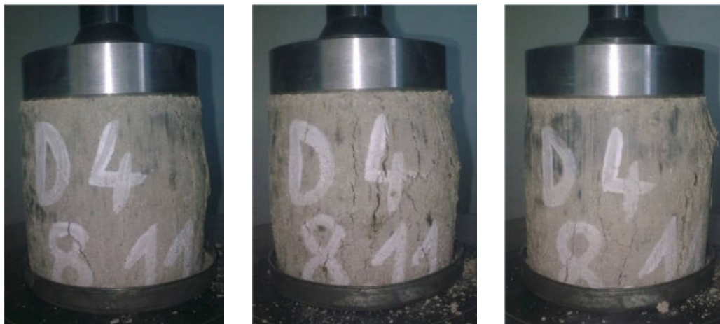
Obr. 3.16: Vyskúšané valčeky na pevnosť v tlaku, Doroport TB 25 4%, w_{opt} = 6,5\%
