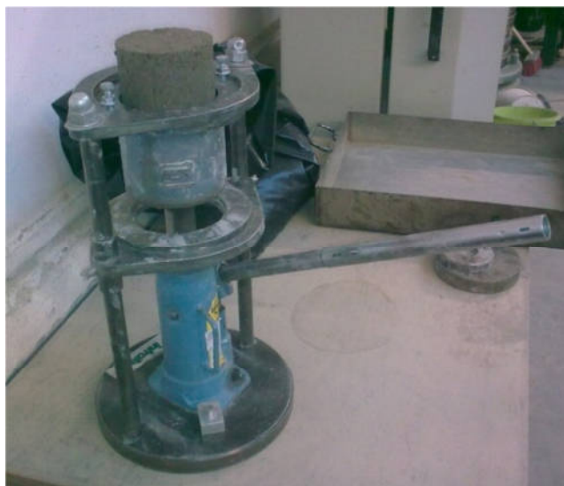
Obr. 3.7: Ručný hydraulický lis na vytlačenie valčekov z formy
