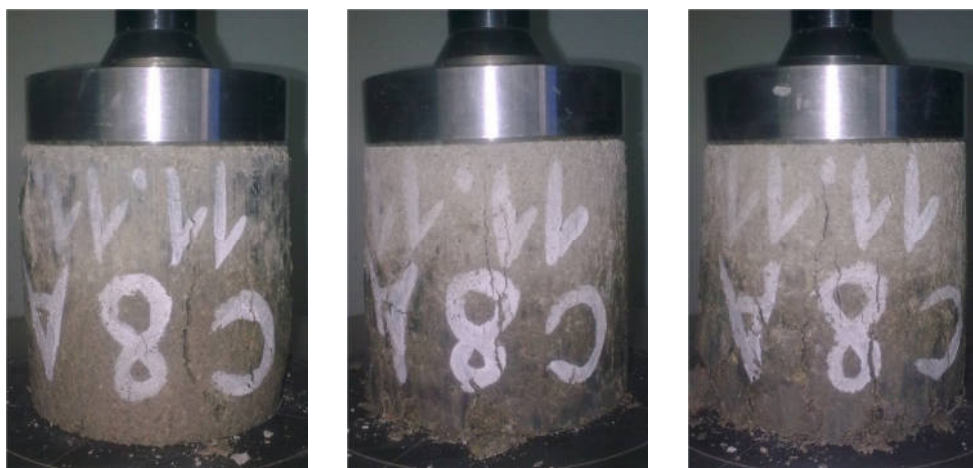
Obr. 3.26: Vyskúšané valčeky na pevnosť v tlaku po MC, cement 8%, w_{opt} = 6,5\%
