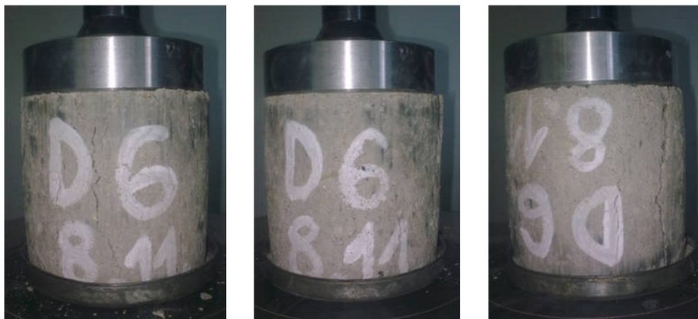
Obr. 3.17: Vyskúšané valčeky na pevnosť v tlaku, Doroport TB 25 6%, w_{opt} = 6,5\%
