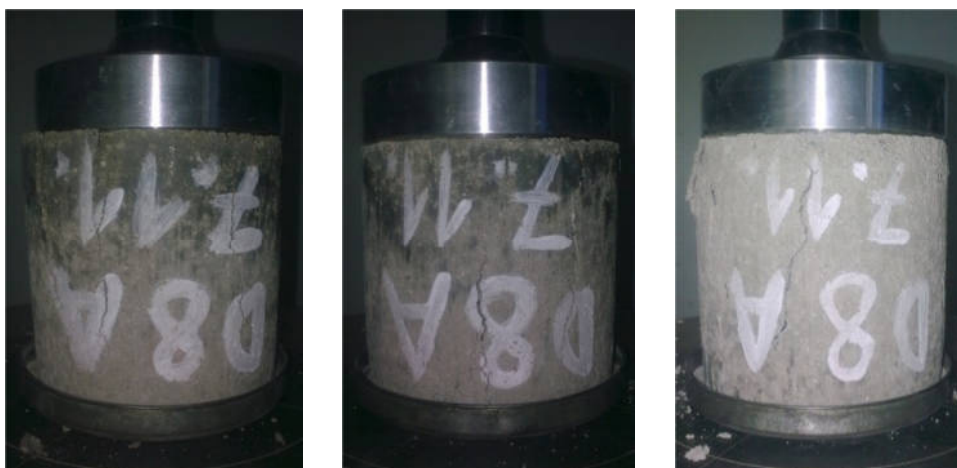
Obr. 3.32: Vyskúšané valčeky na pevnosť v tlaku po MC, Doroport TB 25 8%, w_{opt} = 6,5\%
