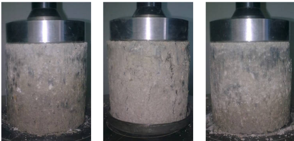
Obr. 3.19: Vyskúšané valčeky na pevnosť v tlaku, Doroport TB 25 8%, w_{opt} = 9,5\%
