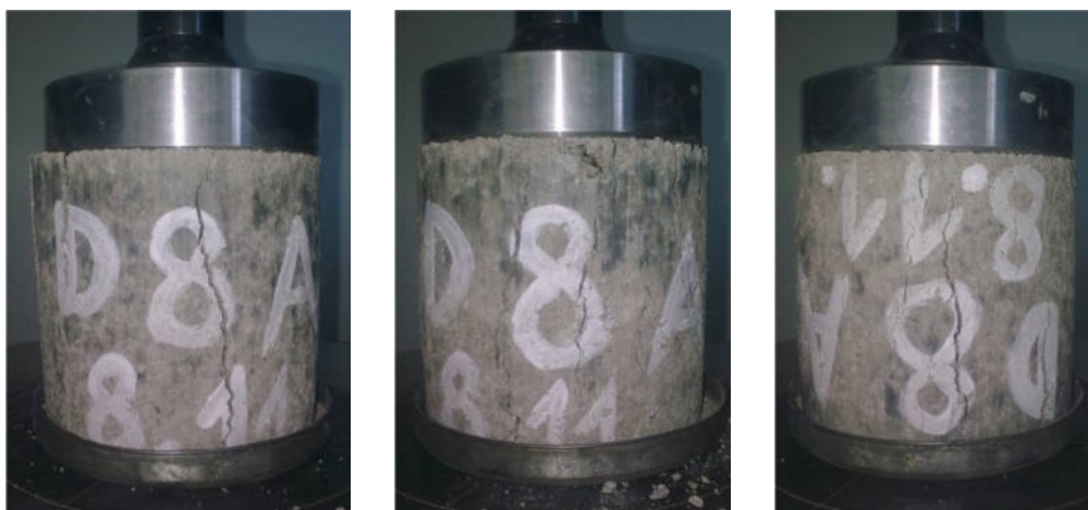
Obr. 3.18: Vyskúšané valčeky na pevnosť v tlaku, Doroport TB 25 8%, w_{opt} = 6,5\%
