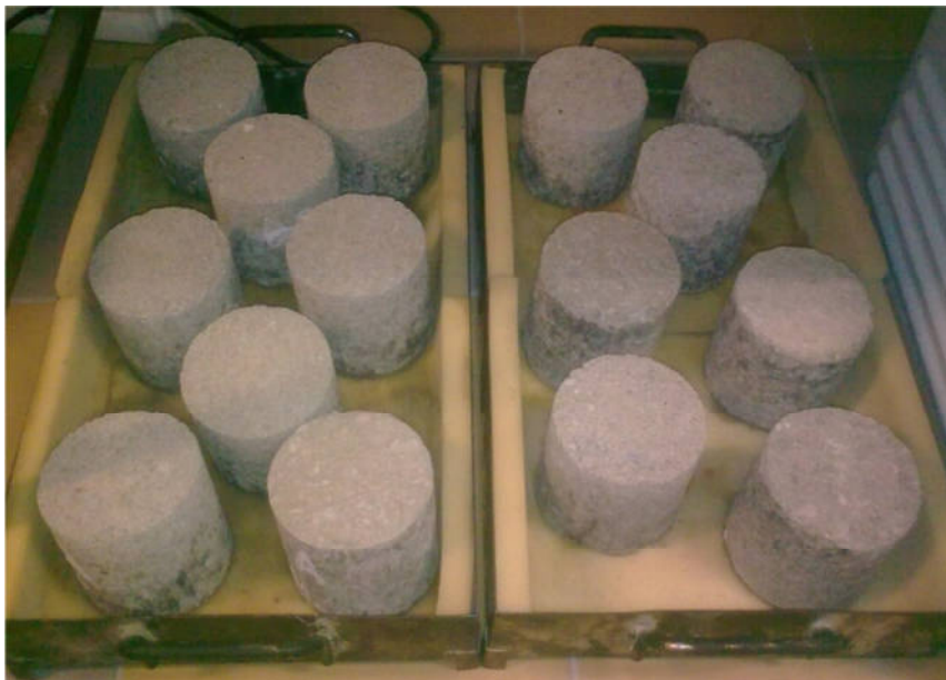
Obr. 3.22: Vzorky uložené na plstenej podložke (fáza rozmrazovania)
