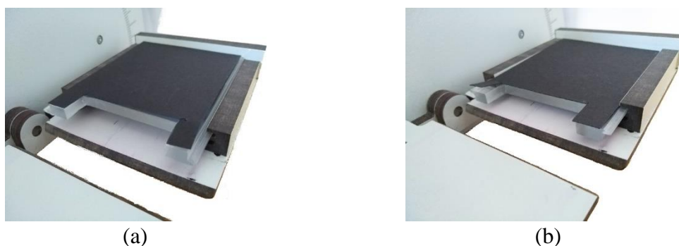
Obrázek 9: Upevnění krycí destičky pro materiály o tloušťce 4 mm (a) a 6 mm (b)
