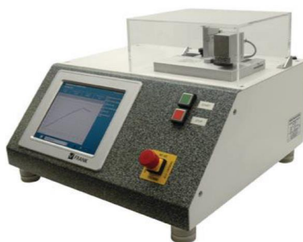
Obrázek 1: Přístroj Taber měřící ohybovou tuhost [7]
