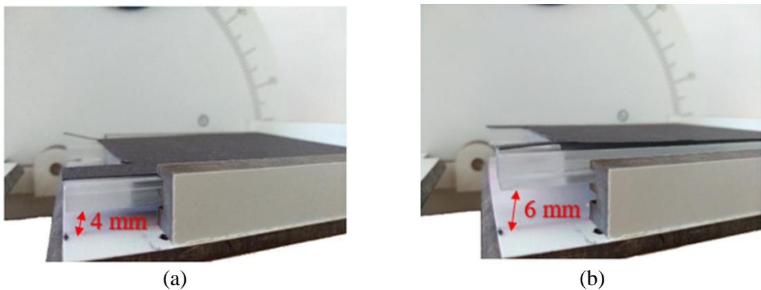
Obrázek 10: Krycí destička upevněna ve vzdálenosti 4 mm (a) a 6 mm (b) od plochy čelisti
