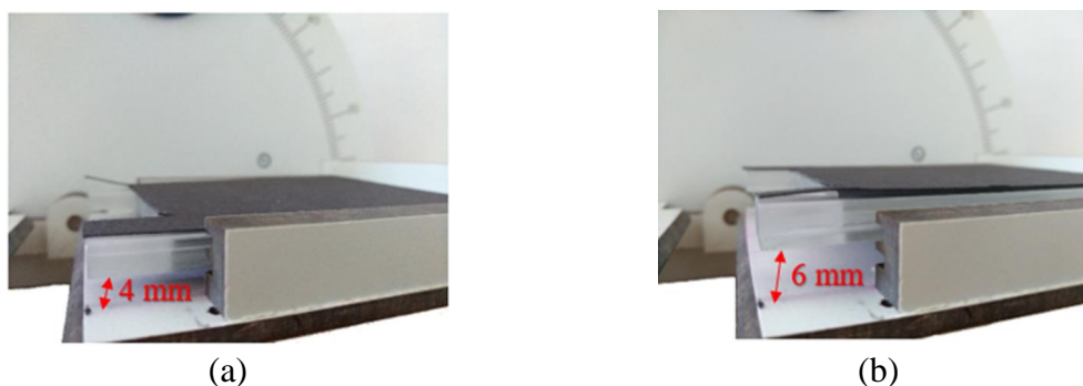
Obrázek 10: Krycí destička upevněna ve vzdálenosti 4 mm(a) a 6 mm (b) od plochy čelisti
