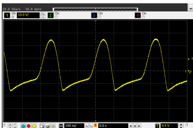
Obrázek 5.6 Výstupní průběh zesilovače ve třídě B na frekvenci 3,5 MHz.
