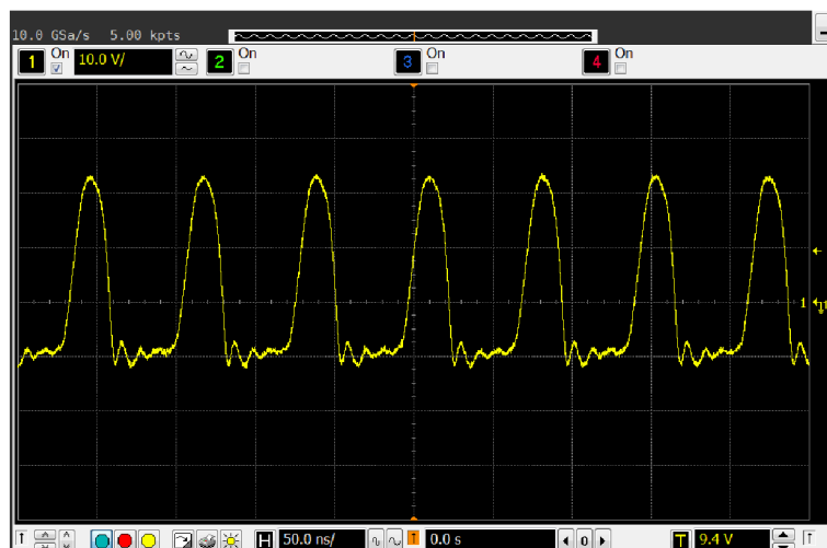
Obrázek 5.11 Výstupní průběh zesilovače ve třídě C na frekvenci 14 MHz.
