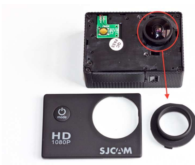
Obr. 4.9: Odstranění aretačního kroužku objektivu.
