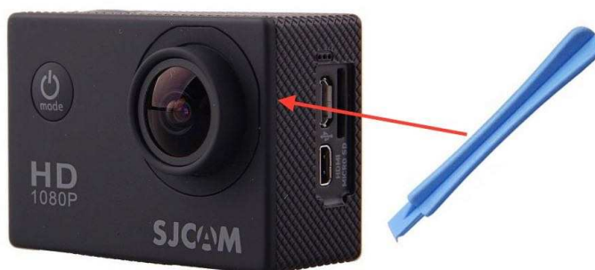
Obr. 4.7: Odstranění předního krytu kamery.
