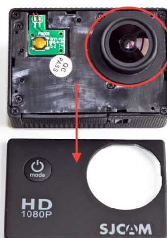
Obr. 4.8: Kamera s odstraněným předním krytem.
