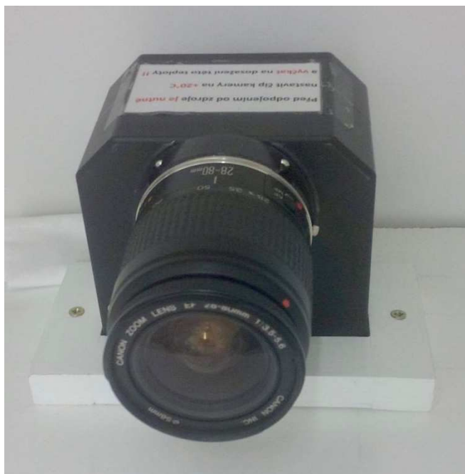
Obr. 4.2: Kamera Moravské přístroje KAF – 3200ME s objektivem.
