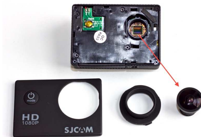
Obr. 4.10: Kamera s demontovaným objektivem.
