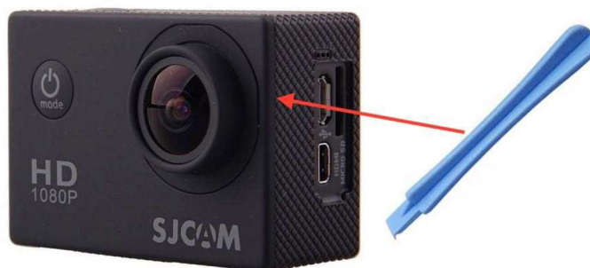
Obr. 4.7: Odstranění předního krytu kamery.
