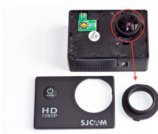
Obr. 4.9: Odstranění aretačního kroužku objektivu.
