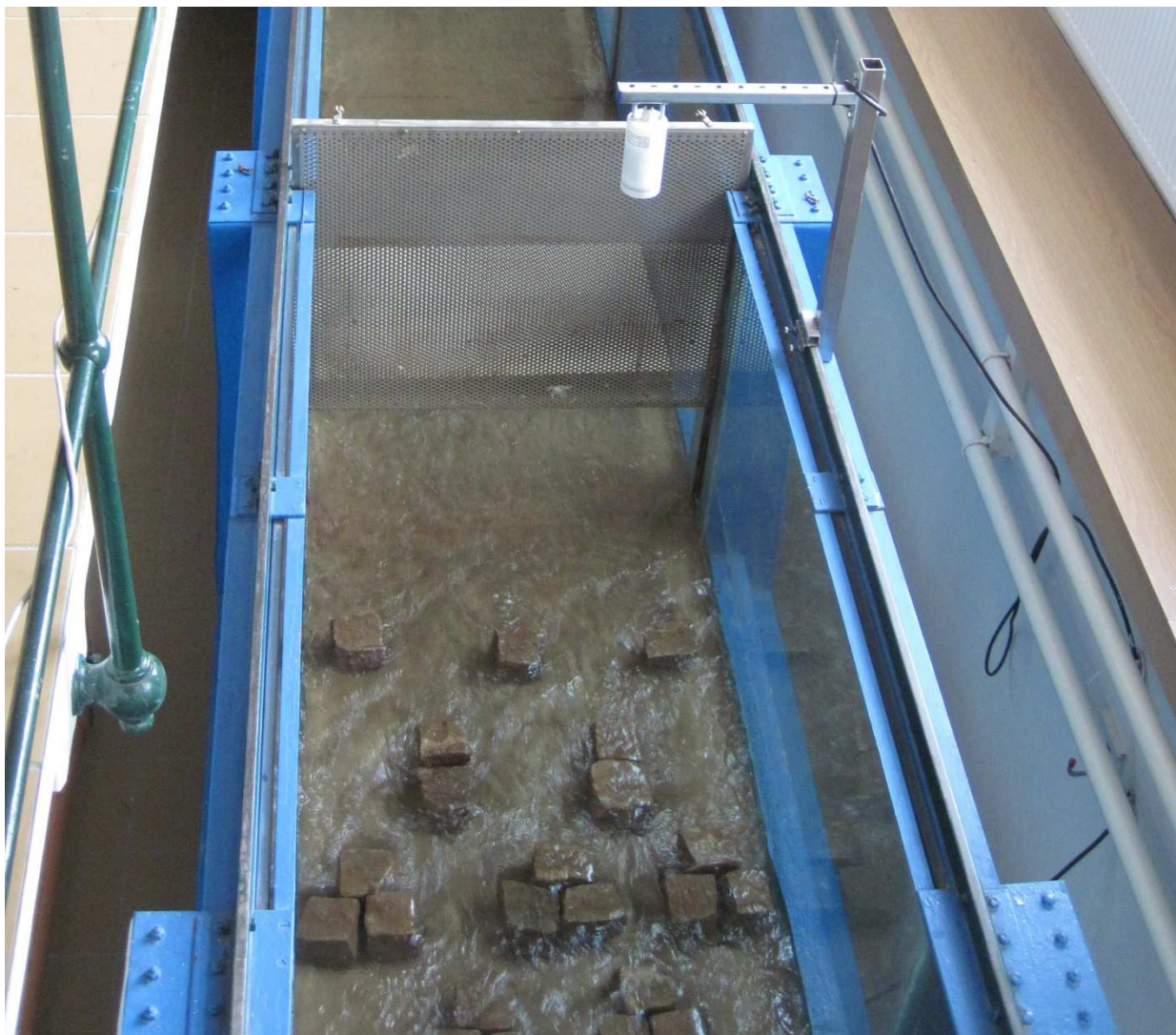
Obr. 7.1 Nastavení žulových kostek do prostoru žlabu
