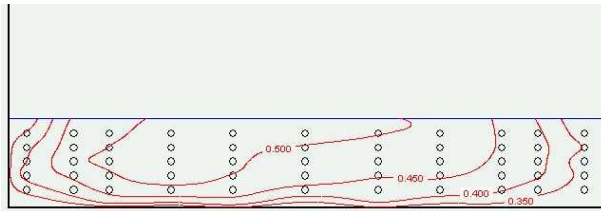
Obr 3.1 – Izočáry rychlostí vytvořené v programu Hydro11
