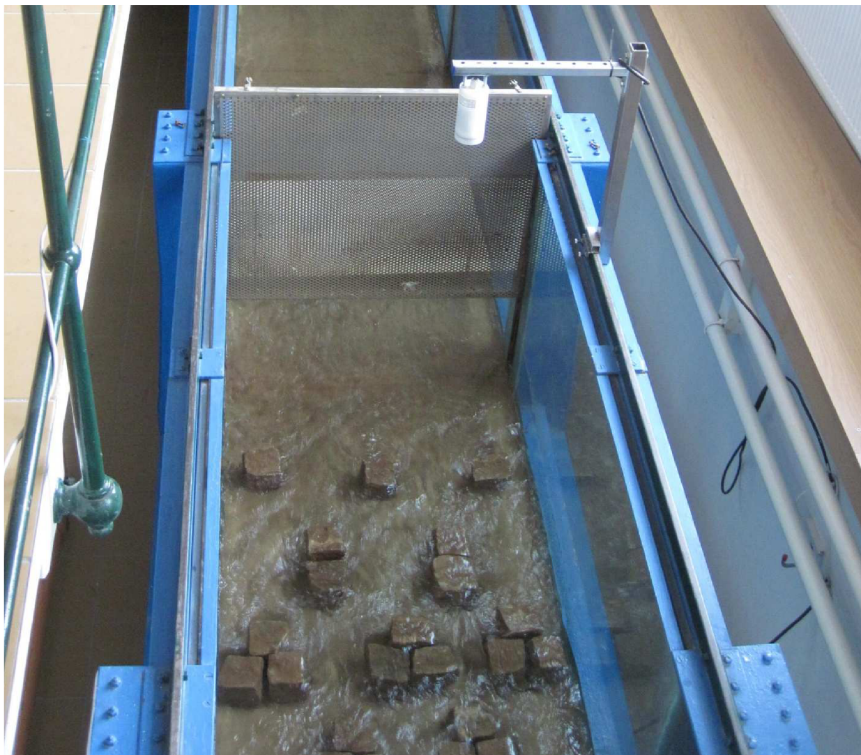
Obr. 7.1 Nastavení žulových kostek do prostoru žlabu
