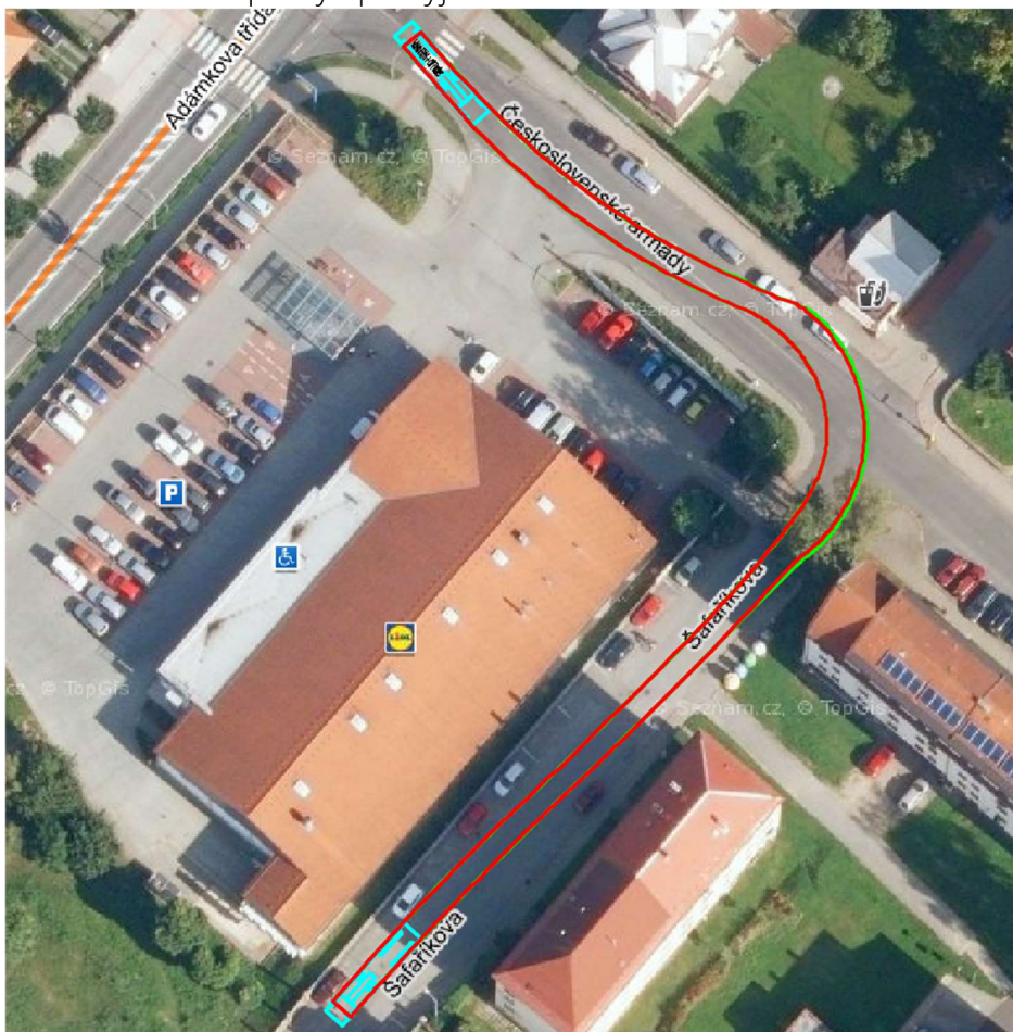
Obrázek 3.10 Snímek z programu Vehicle tracking – směr příjezdu ke staveništi
