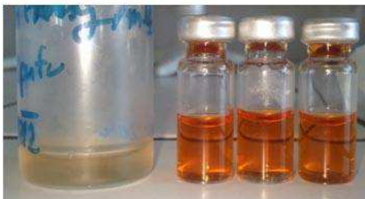
Obr. 12. Srovnání vzorku v čase 0 a 1 hodina rozkladu v roztoku o pH 7 při 95°C
