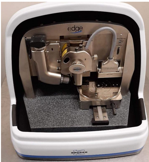
Figure 46: Dimension Edge AFM (Bruker, USA)
