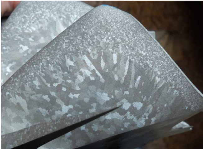
Obr. 7.4.2.1 Struktura lopatky kola 0 s klidným tuhnutím
