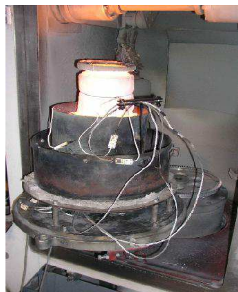
Obr. 6.3 Schéma umístění skořepiny v kokilové komoře vakuové pece [17]
