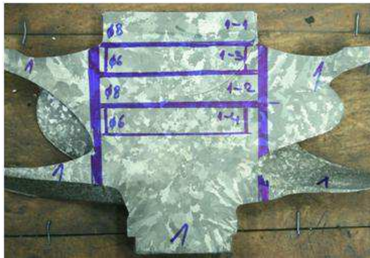
Obr. 7.6.1.3 Průřez kola s označenými místy pro vyříznutí tyček
