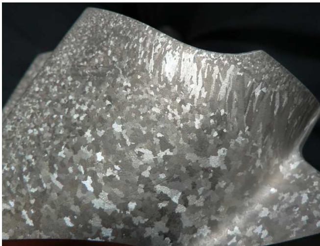
Obr. 7.4.2.2 Struktura lopatky kola 1 s klidným tuhnutím
