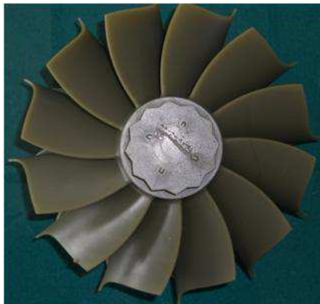
Obr. 7.1.1 Voskový model turbínového kola.
