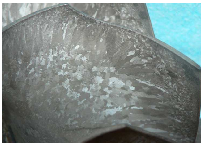
Obr. 7.4.1.2 Struktura lopatky kola 3 vlivem oscilací
