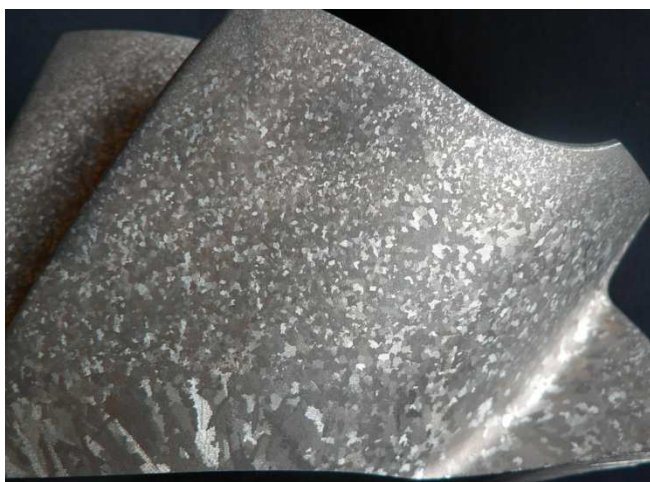
Obr. 7.4.1.1 Struktura lopatky kola 2 vlivem rotací
