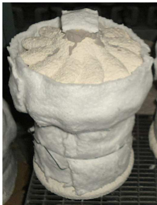
Obr. 7.1.4 Obalení skořepiny izolací Sibrál
