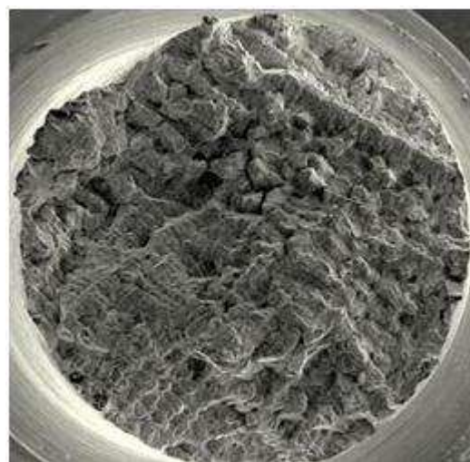
Obr. 7.7.3 Lomová plocha - tyčka z kola 2
