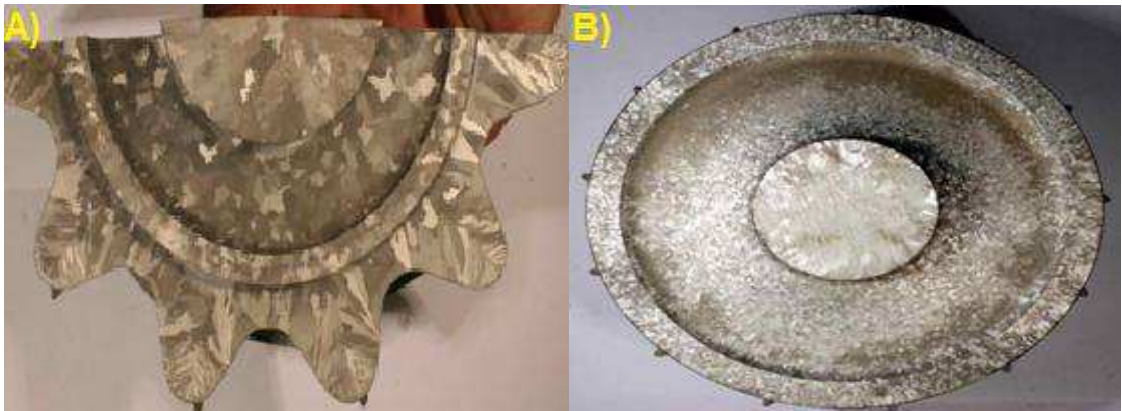
Obr. 5.1.1 Vliv velikosti teploty lití na strukturu
