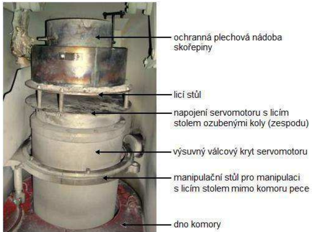
Obr. 7.1.5 Popis zařízení pro rotaci a oscilaci skořepin
