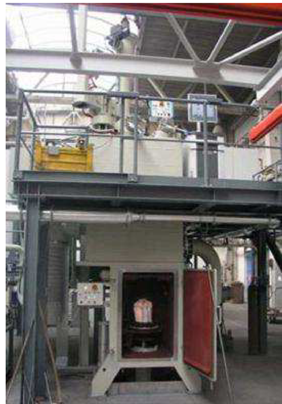
Obr. 6.5 Schéma dvoukomorové vakuové indukční pece s vertikálním uspořádáním komor [17]
