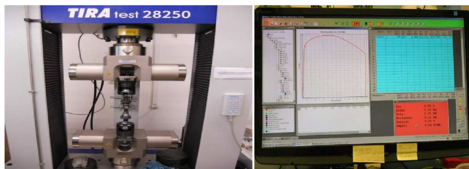
Obr. 7.6.1.2 Trhací stroj TIRA Test společně s vyhodnocovacím softwarem
