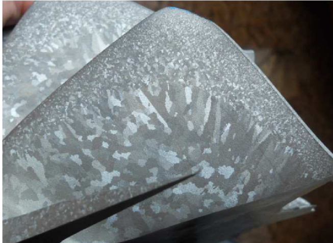
Obr. 7.4.2.1 Struktura lopatky kola 0 s klidným tuhnutím
