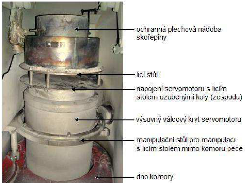
Obr. 7.1.5 Popis zařízení pro rotaci a oscilaci skořepiny
