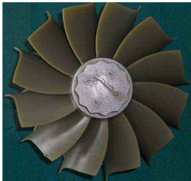
Obr. 7.1.1 Voskový model turbínového kola.
