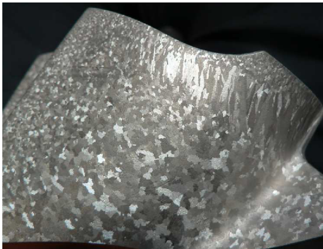
Obr. 7.4.2.2 Struktura lopatky kola 1 s klidným tuhnutím
