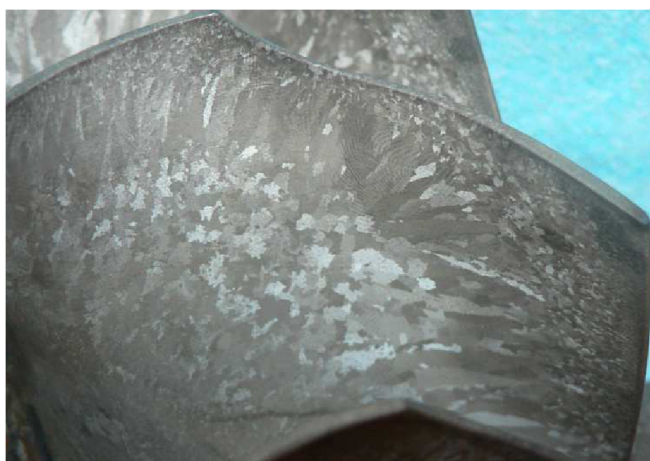
Obr. 7.4.1.2 Struktura lopatky kola 3 vlivem oscilací
