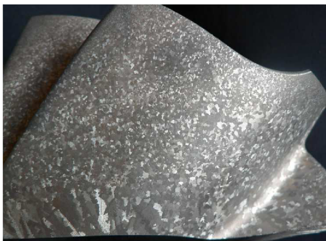
Obr. 7.4.1.1 Struktura lopatky kola 2 vlivem rotací
