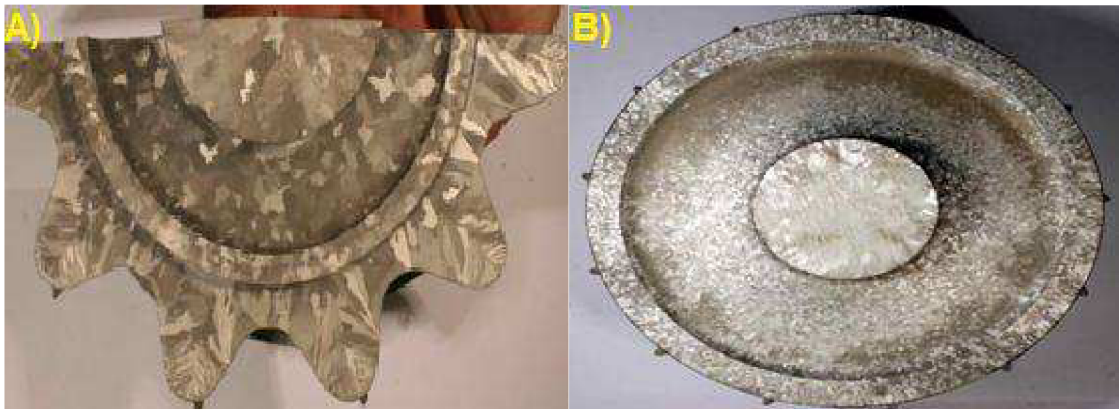
Obr. 5.1.1 Vliv velikosti teploty lití na strukturu
