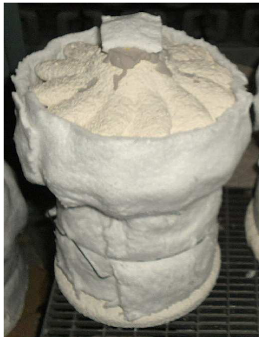
Obr. 7.1.4 Obalení skořepiny izolací Sibrál
