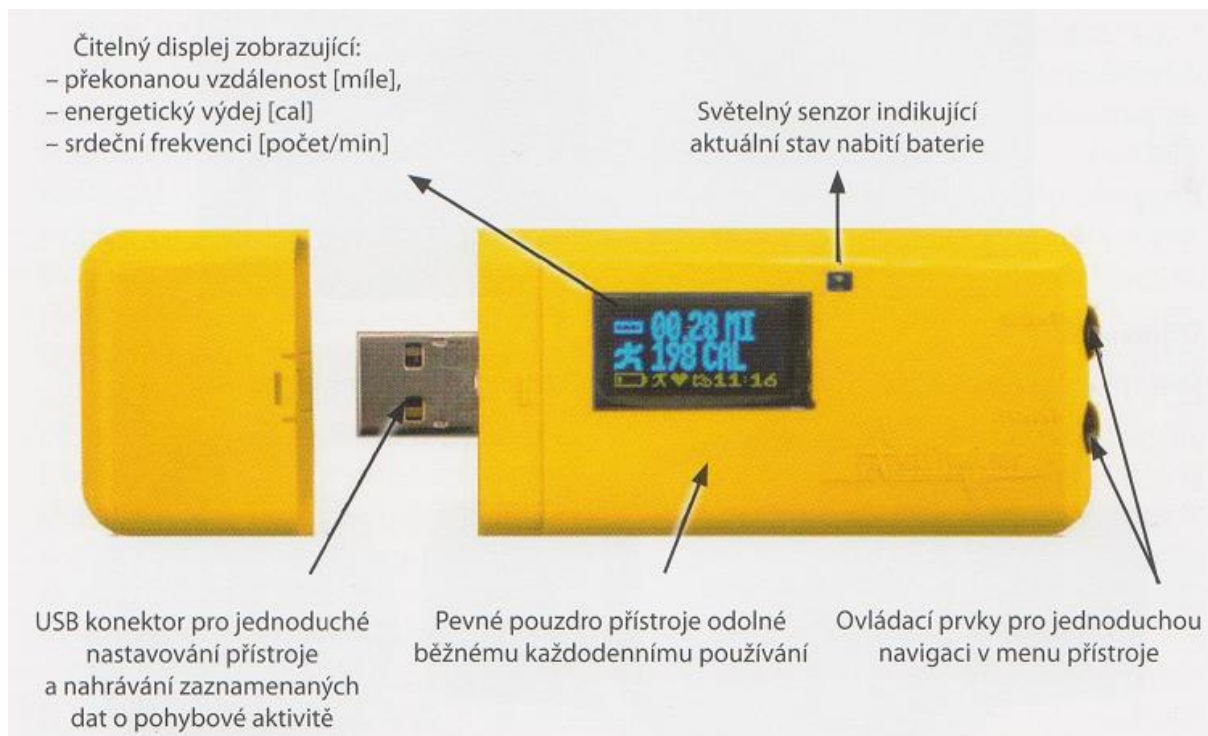
Obrázek 6 Multifunkční monitorovací přístroj Actitrainer (akcelerometr + pedometr + inklinometr + snímač tepové frekvence)
