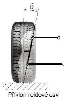
Obr. 11 Příklon rejdové osy
