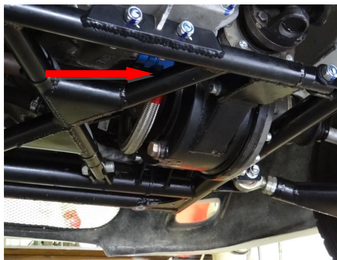
Obr. 22 Uložení diferenciálu pro přední náhon
