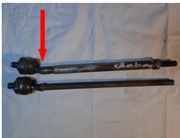
Obr. 34 Zdeformovaná axiální táhla řízení
