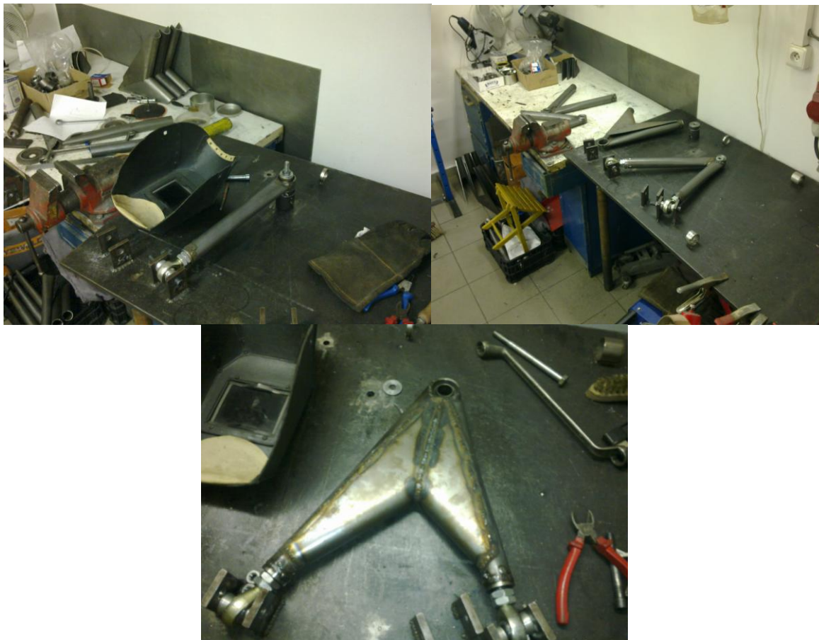
Obr. 25 Postup výroby ramene pro závodní účely
