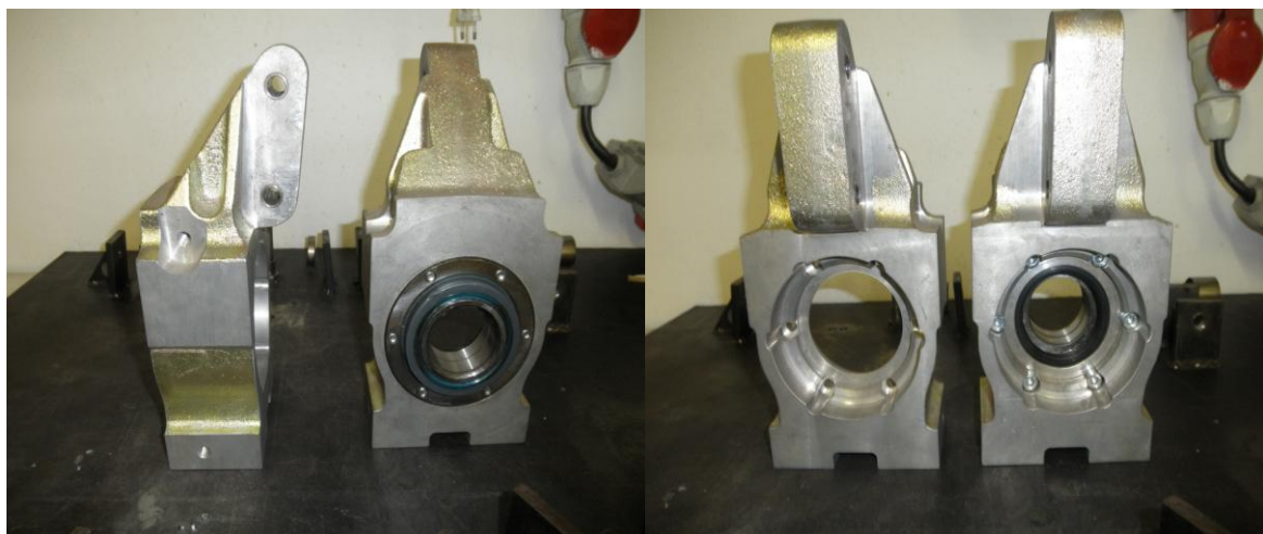
Obr. 27 Hlavy kol z hořčíkové slitiny vozu Ford Focus T16
