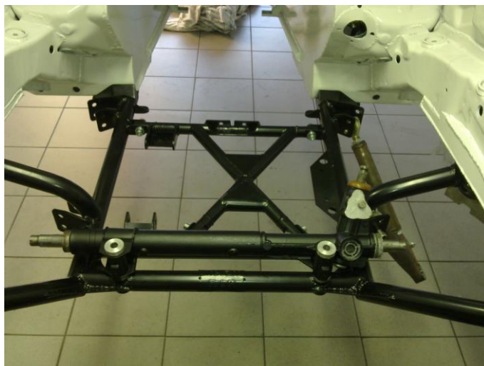
Obr. 23 Přední koš nápravy vozu Ford Focus T16
