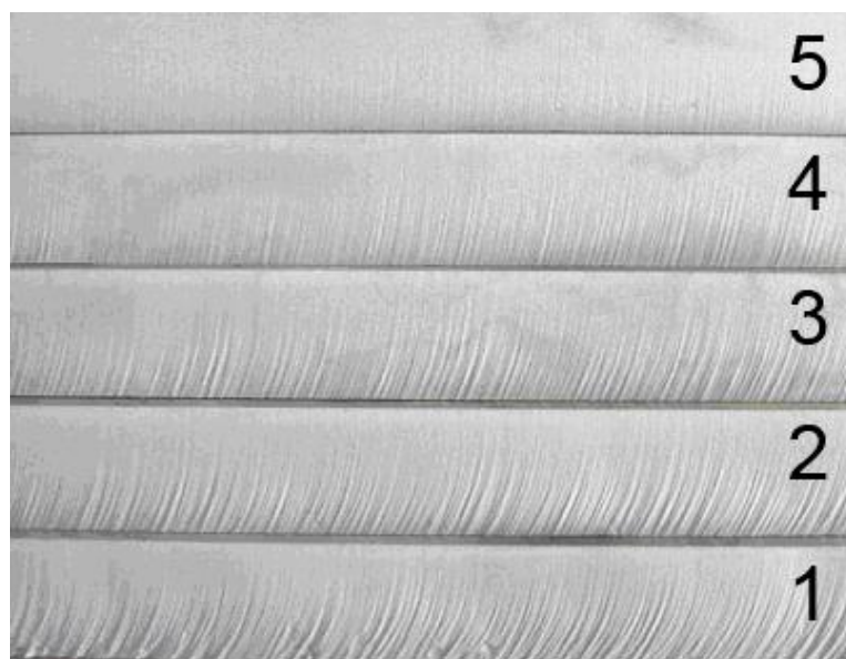
Obr. 6. Kvalitativní skupiny řezů vodním paprskem (ELNA Servis s. r. o., 2015)
