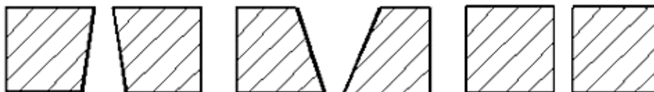
Obr. 7. Geometrie řezné spáry (CHPS s. r. o., 2015)
