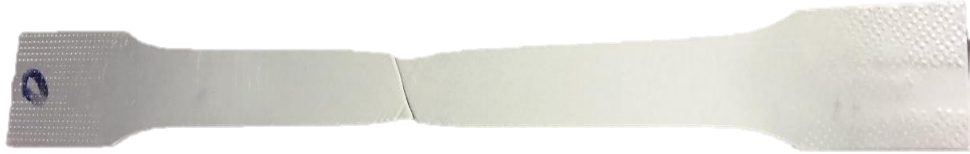
Obr. 3.5. Porušená zkušební tyčka.
