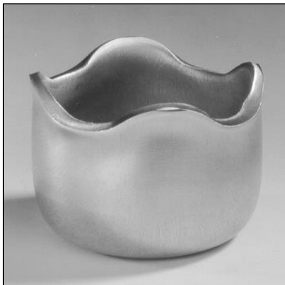
Obr 2.15. Typická cípatost u vytaženého kalíšku pod 0° a 90° ke směru válcování plechu. [23]
