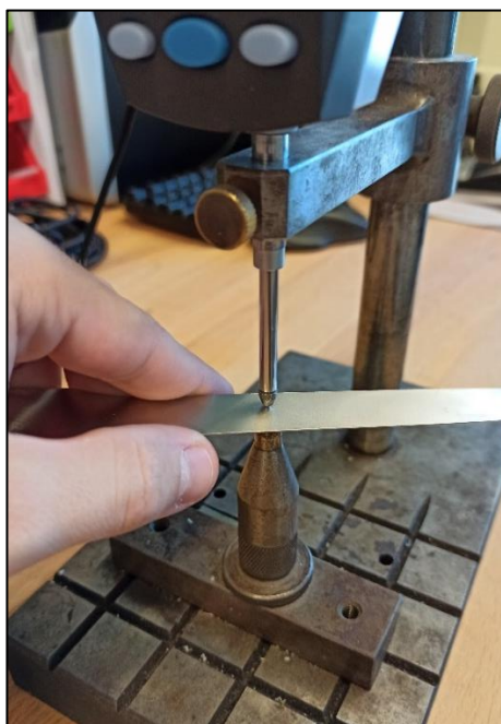
Obr. 3.3. Měření rozměrů zkušební tyčky pomocí úchylkoměru MITUTOYO.
