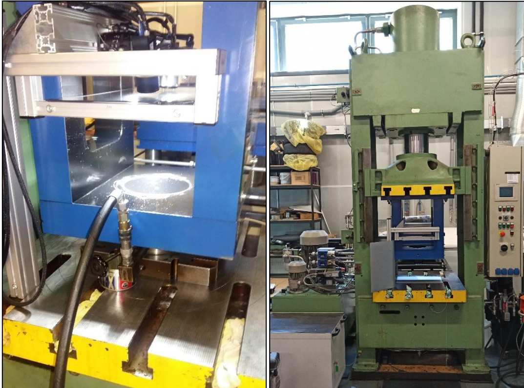
Obr. 3.13. Dvojčinný hydraulický lis CBA 300/63 s připevněnými kamerami.
