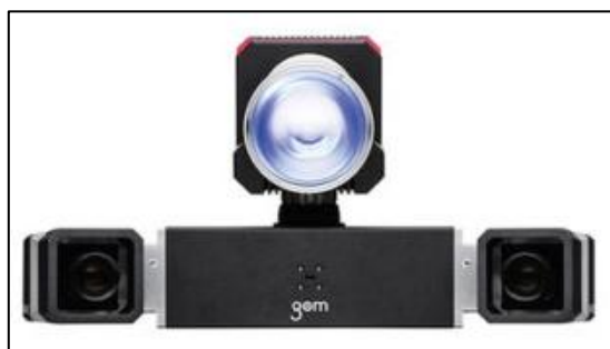
Obr.2.23. Bezkontaktní optický systém ARAMIS [30]
