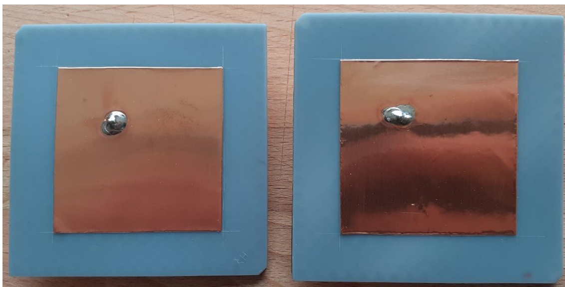
Obrázek 4.8 Zhotovené antény – s rozloženou relativní permitivitou pomocí polynomu (vpravo), s adekvátní efektivní permitivitou (vlevo)
