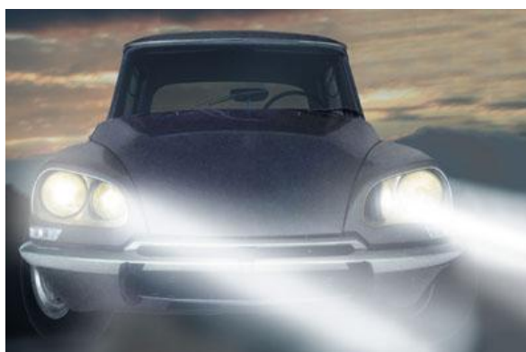
Obr. 56 Přední část III. generace s natáčecími světly [87]
