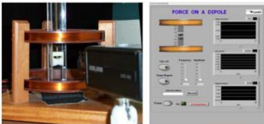
Obrázek 11 - Experiment „The force on a dipole“, prováděný na iLab zdroj: Scheucher et al., 2009
