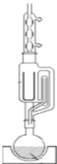
Obrázek č. 3: Apartura dle Soxhleta
