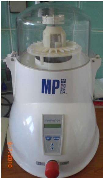
Obr. 4 : Homogenizátor (FastPrep®-24, M.P. Biomedicals, CA, USA)
