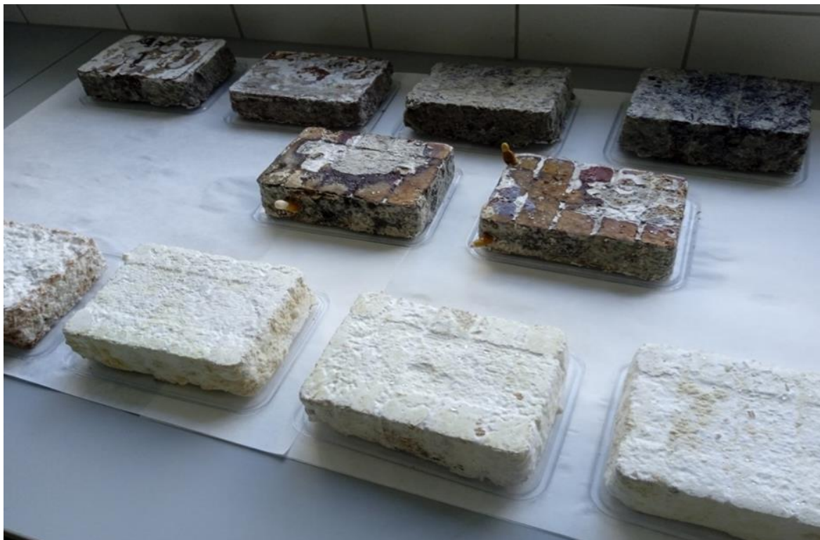
Příloha č. IX – obrázek č. 13. Mykokompozity vypěstované na substrátech obohacených 20% přídavkem pšeničných otrub (pokus č. 4); G. sessile – tmavé, T. hirsuta – bílé. Je patrné, že jsou bloky dobře prorostlé hyfami.
