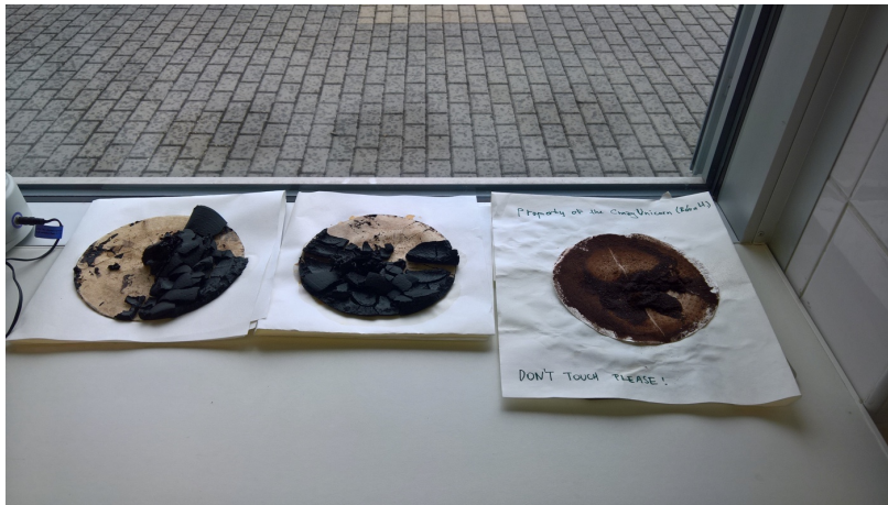
Obrázek 6: sušení materiálu po syntéze (AMO, AMOchar)
