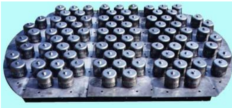
Obr. 24: Patro využívající technologii bubble cap [53]
