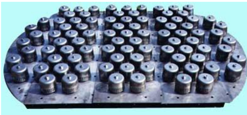
Obr. 24: Patro využívající technologii bubble cap [53]
