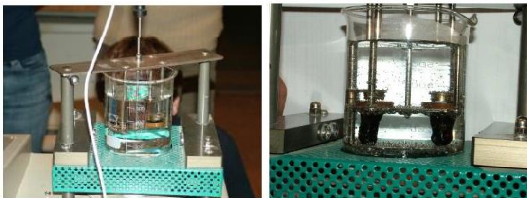
Obrázek 5-14: Zkouška stanovení bodu měknutí kroužkem a kuličkou [13]
