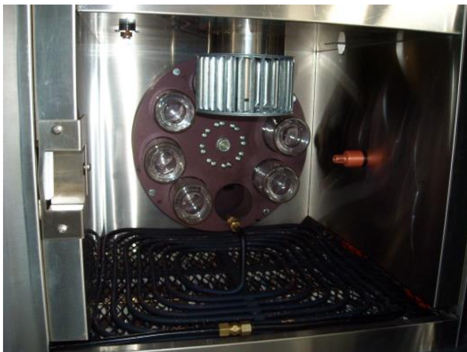
Obrázek 3-2: Detailní pohled do komory zařízení pro RTFOT [5]
