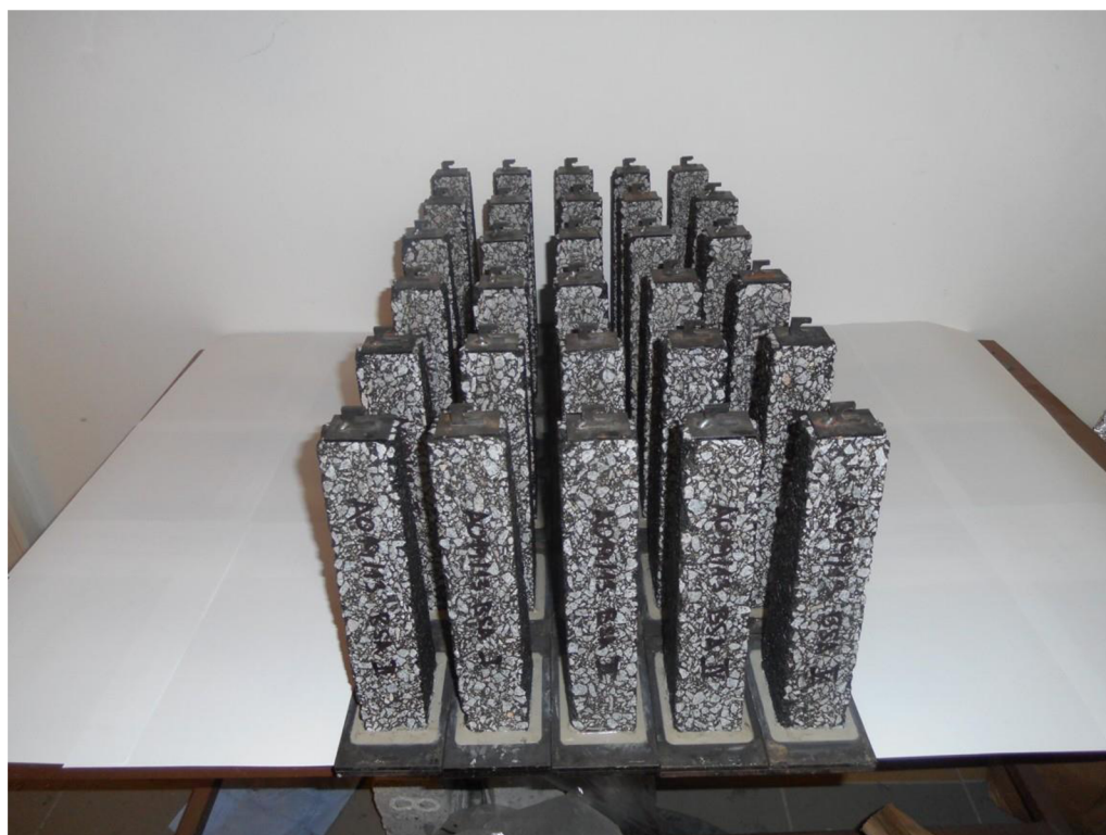
Obrázek 5-11: Trapézoidy připravené pro zkoušku stanovení modulu tuhosti
