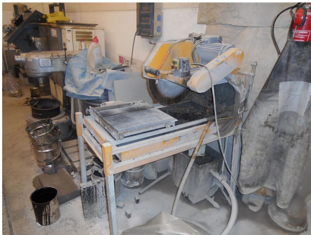
Obrázek 5-10: Kotoučová pila pro řezání trapézoidů
