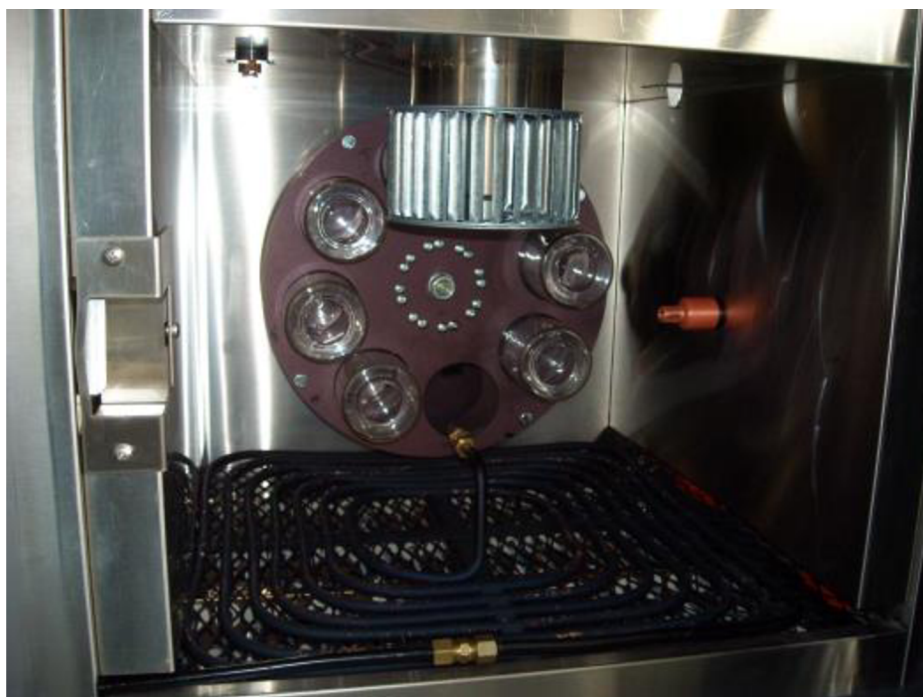
Obrázek 3-2: Detailní pohled do komory zařízení pro RTFOT [5]
