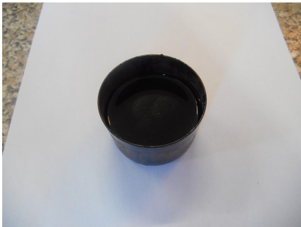
Obrázek 5-4: Miska s asfaltovým pojivem pro zkoušku penetrace jehlou
