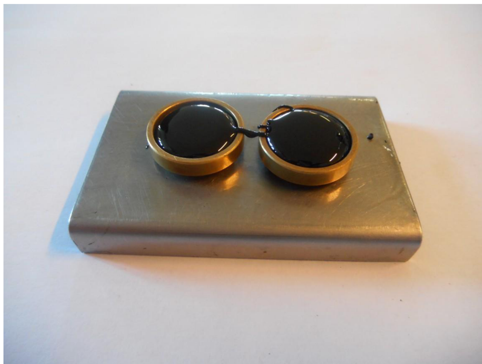
Obrázek 5-5: Těliska pro zkoušku „Kroužek – kulička“
