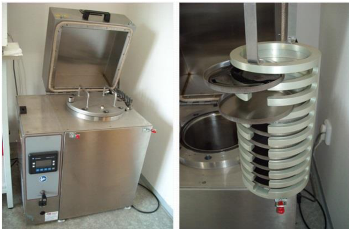
Obrázek 3-5: Aparatura pro zkoušku v tlakovém hrnci PAV [5]
