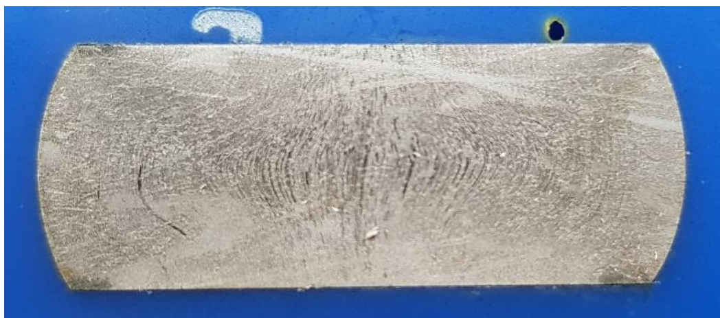
Obr. 50 Makroštruktúra pechovaného valca na 60 % deformácie
