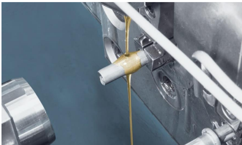
Obr. 20 Mazanie pri tvárnení za studena [37]
