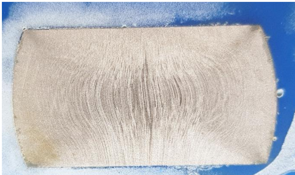
Obr. 49 Makroštruktúra pechovaného valca na 50 % deformácie
