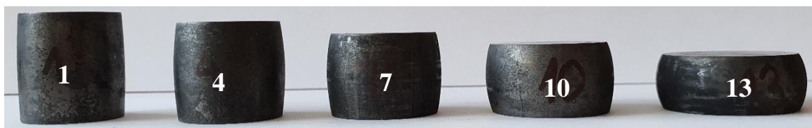
Obr. 47 Spechované namazané valcové vzorky
