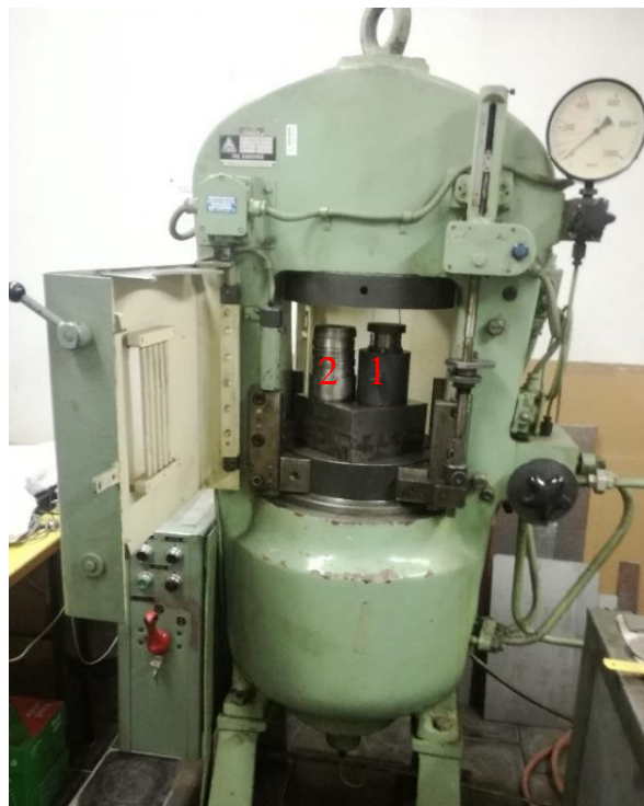
1 – nástroj, 2 - doraz Obr. 39 Hydraulický lis CZR 600
