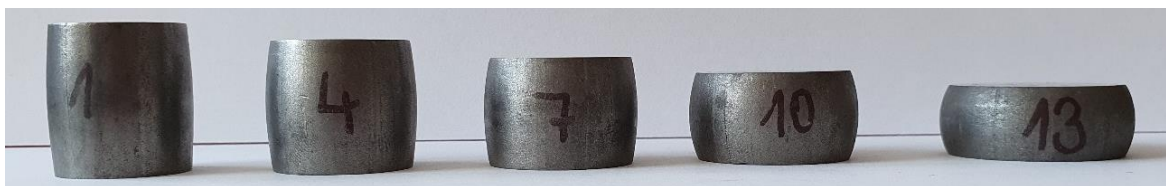
Obr. 46 Spechované nenamazané valcové vzorky
