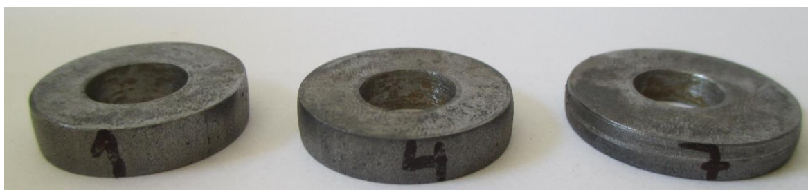
Obr. 41 Nenamazané pechované vzorky prstencov
