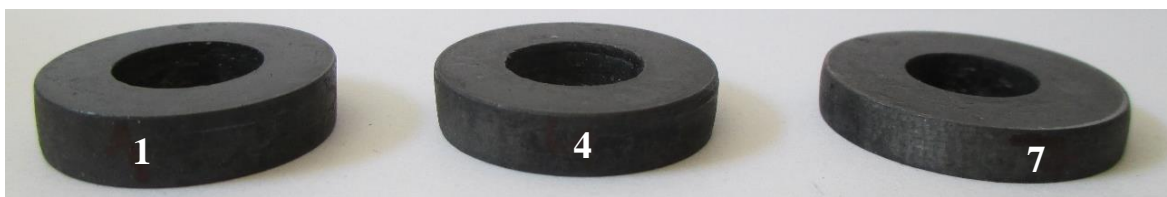
Obr. 42 Namazané spechované vzorky
