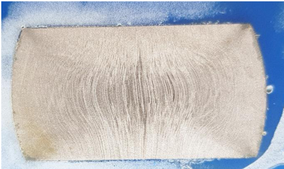
Obr. 49 Makroštruktúra pechovaného valca na 50 % deformácie
