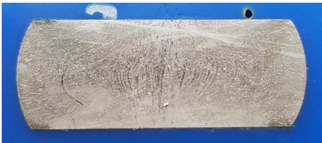
Obr. 50 Makroštruktúra pechovaného valca na 60 % deformácie
