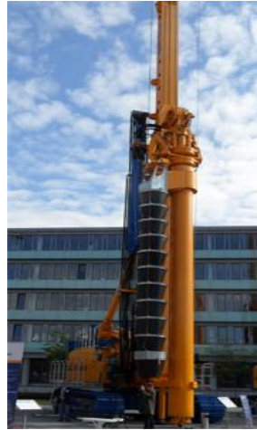
Obr. 14: Vrtací souprava Bauer BG 46 [15]
